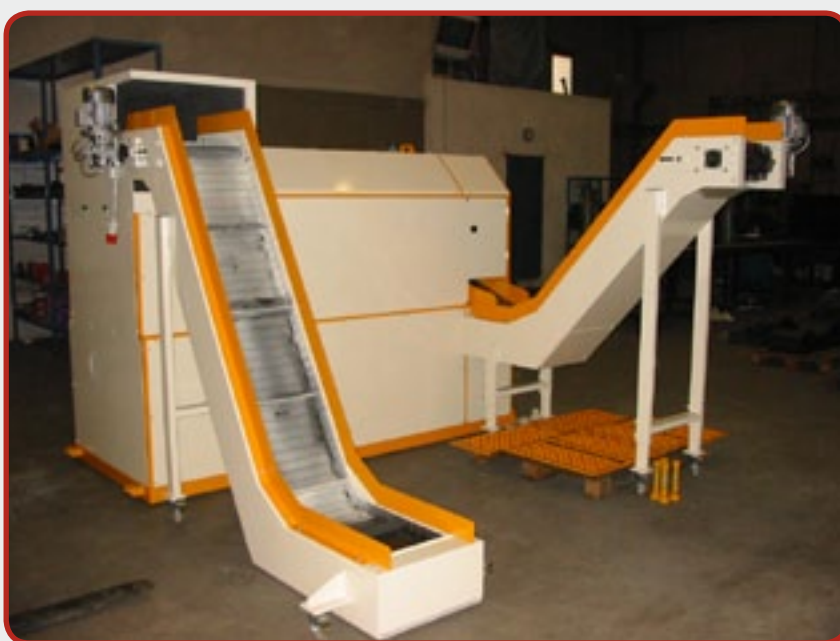
4. 隔音设备 设有分离功能以及增设的两个传送带 (体积尺寸和细节可以根据客户的要求和细节)。
