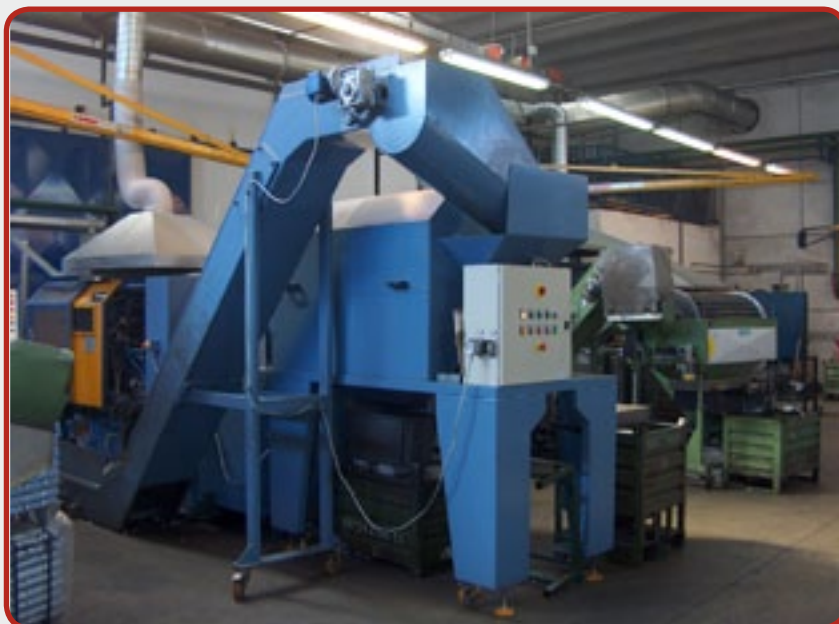
9. Four équipé pour la récupération complète de carottes (dimensions et détails selon la demande du client).
