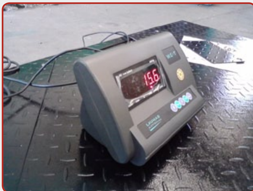
10. Panneau de commande numérique pour balance.
