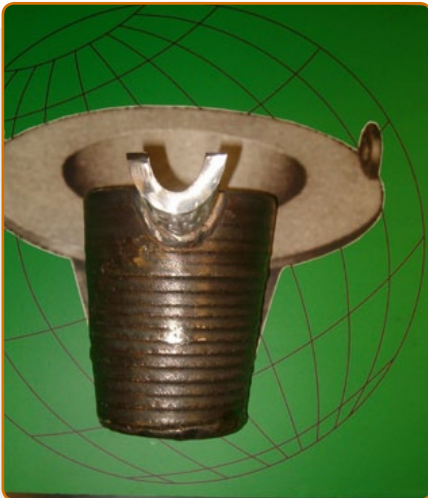
5. Тигли для переработки магниевых сплавов и лабораторных исследований.
