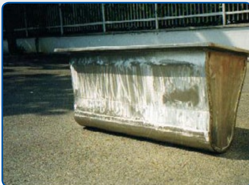
16. Schmelztiegel zum Umschmelzen für Zinklegierungen, Fassungsvermögen 2500 kg.
