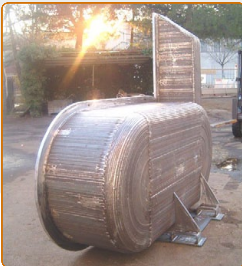
2. Creusets pour refusion d'alliages de magnésium.
