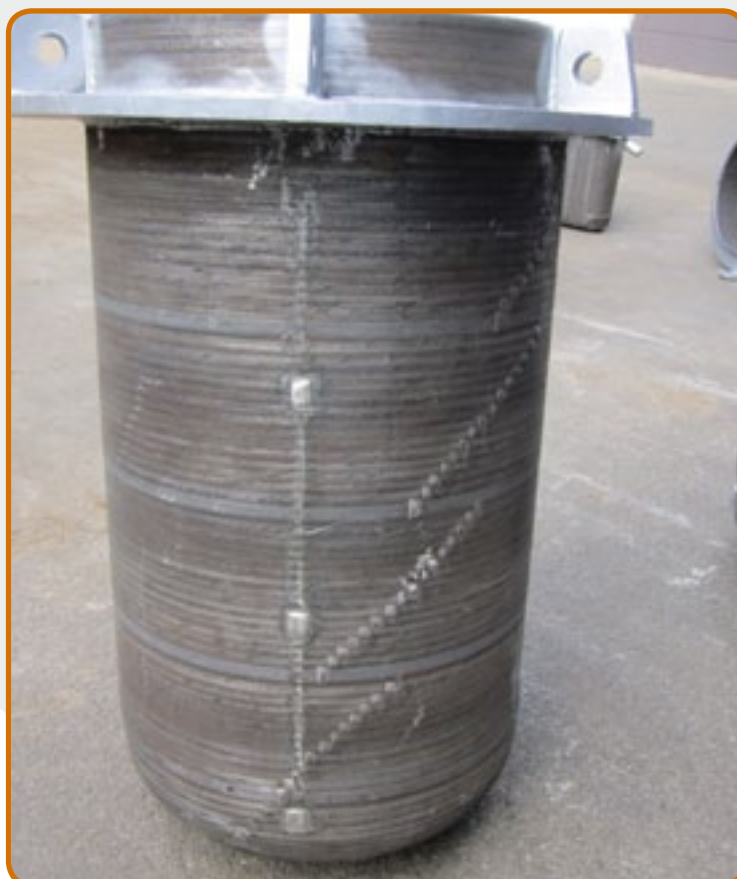
18. Crogiolo per riciclaggio delle leghe di magnesio.
