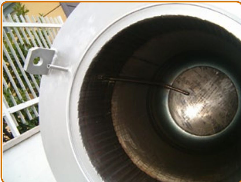
20. Schmelztiegel zum Schmelzen von Magnesiumlegierungen bei niedrigem Druck.
