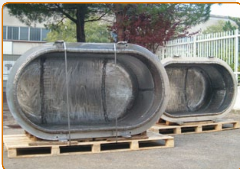
10. Creusets pour le recyclage des alliages de magnésium, capacité de 7 tonnes.
