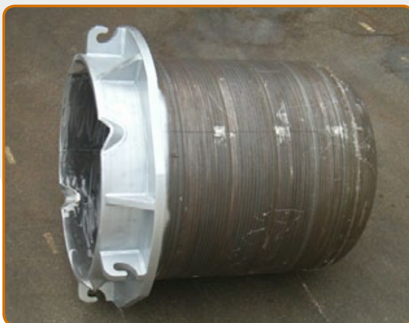
4. Schmelztiegel für die Wiederverwertung von Magnesiumlegierungen.
