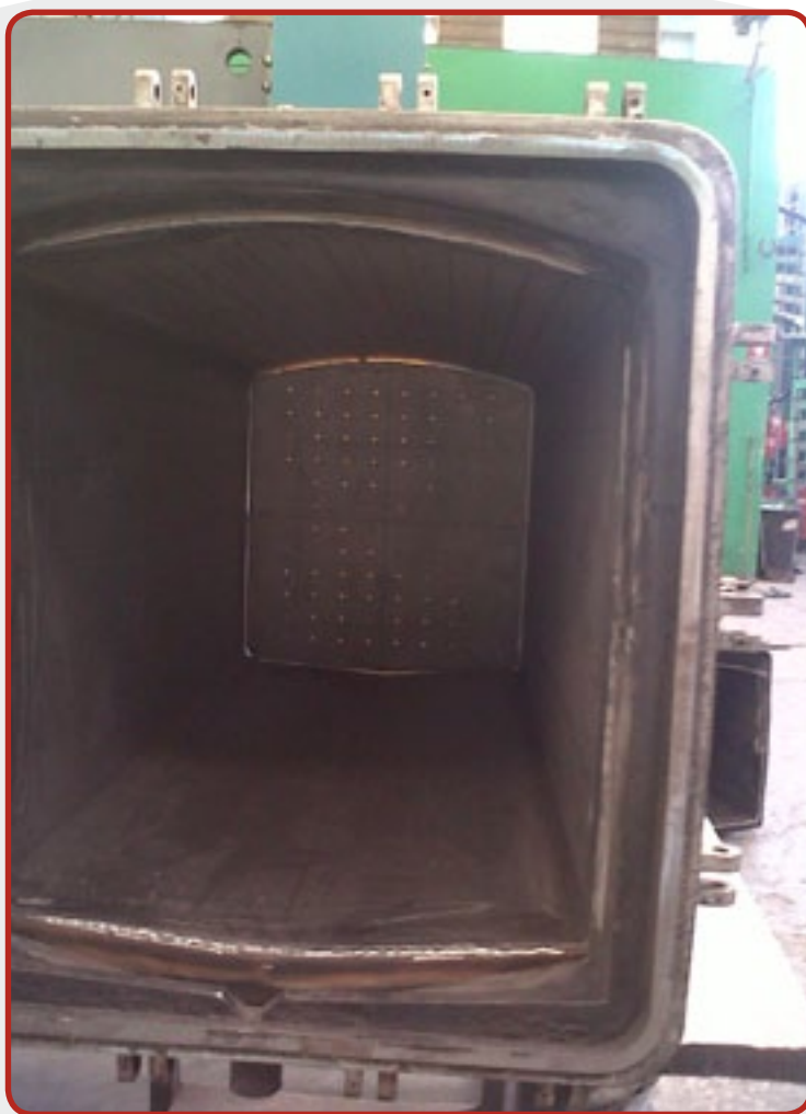
1. Tunnel per trattamenti termici (misure d'ingombro e dettagli secondo richiesta del Cliente).
