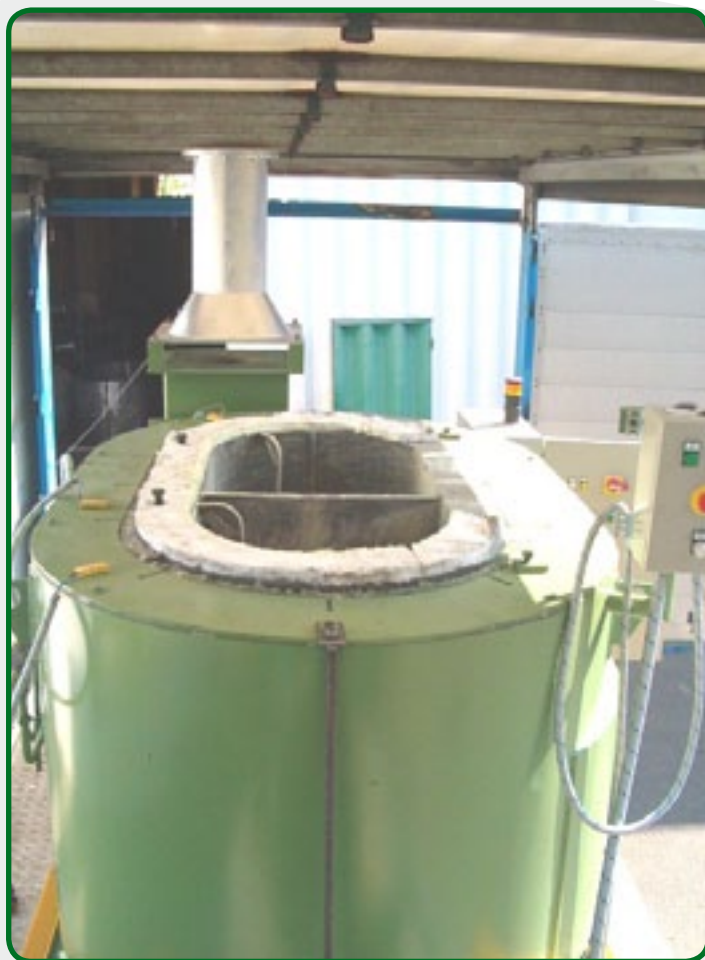
9. Печь тигельная с двумя литниковыми чашами, для магния, вместимость 600 кг.
