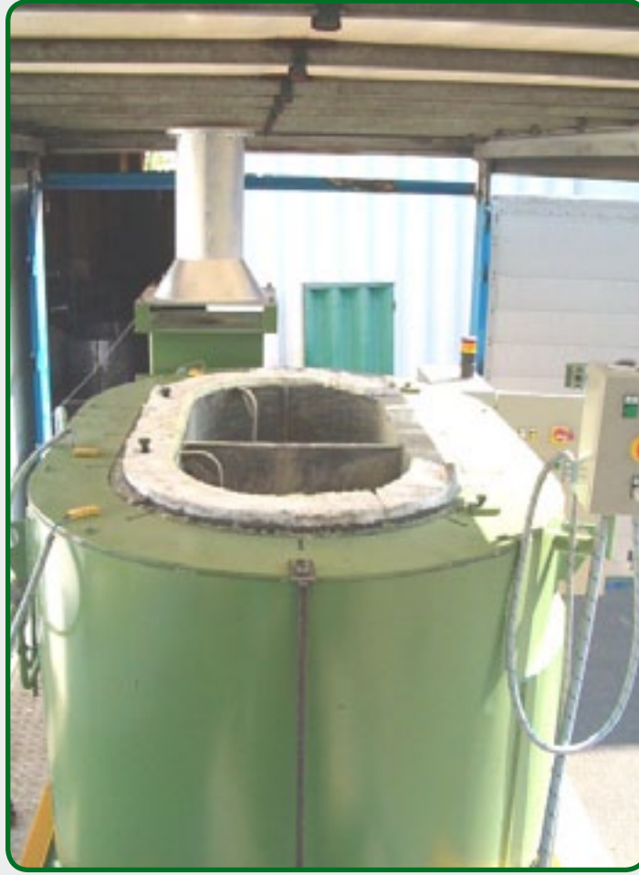
9- فرن ببيتقة حوض مزدوج للمغنيزيوم القدرة ، 600 كغ .
