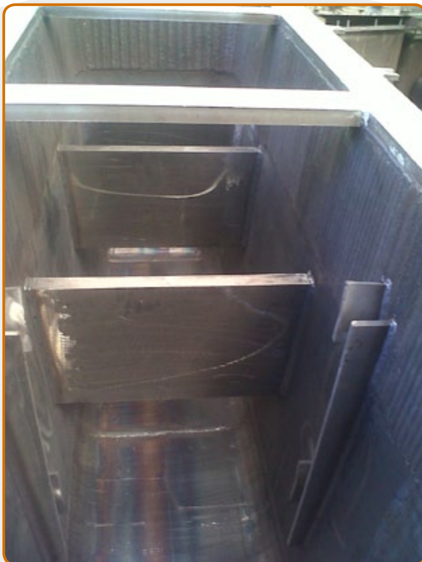
9. Crogioli per riciclaggio delle leghe di magnesio, capacità 2,2 ton.
