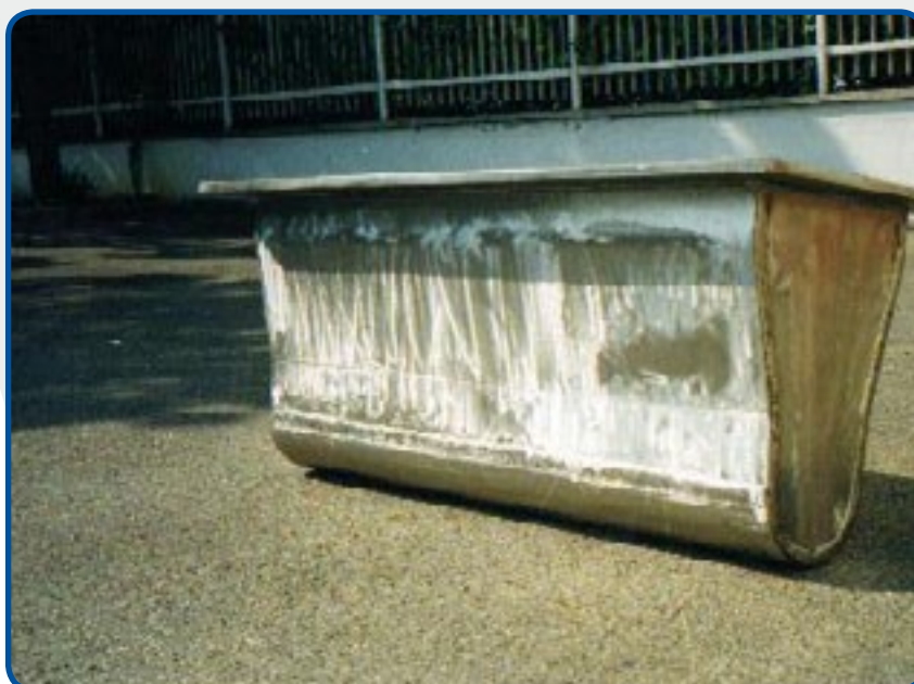
16. Тигель для переплавки цинковых сплавов, вместимость 2500 кг.
