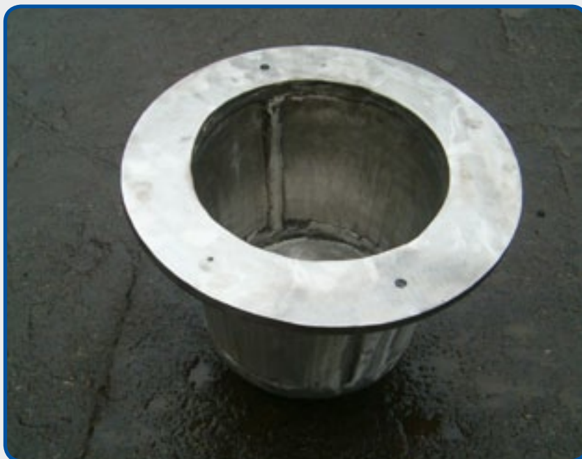
1. Тигель для центробежной установки для производства сплавов Zamak, вместимость 300 кг.
