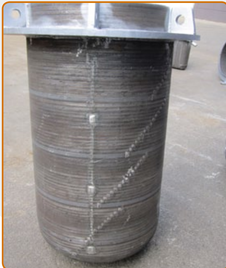
18. Schmelztiegel für die Wiederverwertung von Magnesiumlegierungen.
