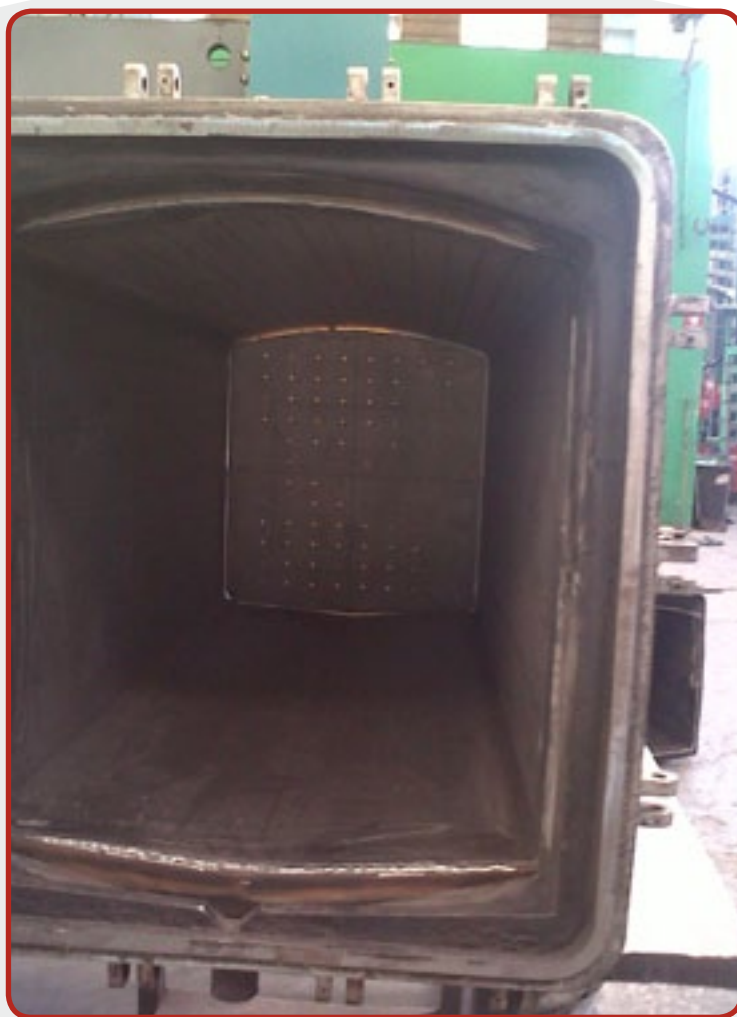
1. 热处理通道 (体积尺寸可以根据客户的要求)。
