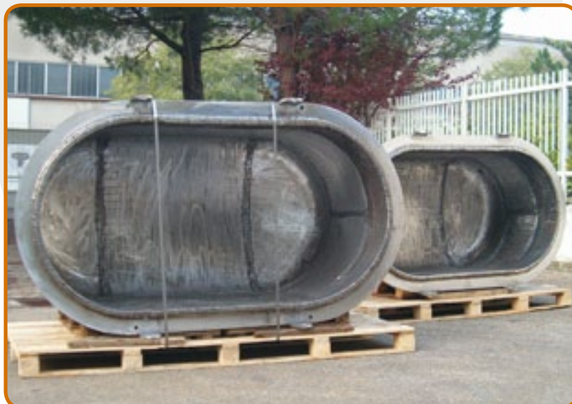
10. Schmelztiegel für die Wiederverwertung von Magnesiumlegierungen, Fassungsvermögen 7 t.
