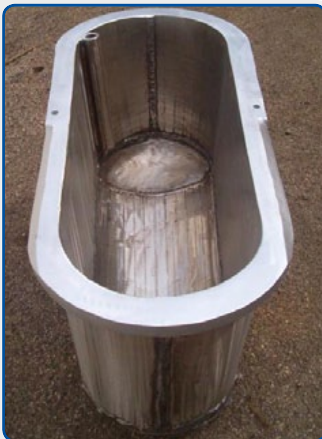
15. Refundición Crisol para aleaciones de cinc, capacidad 2.500 kg.
