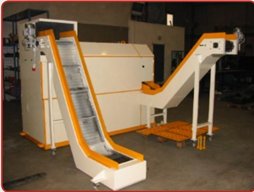
4- نظام عازل للصوت، كامل بالفوارق مع إضافة اثنين من احزمة النقل (الأبعاد والتفاصيل وفقا لطلب العميل)
