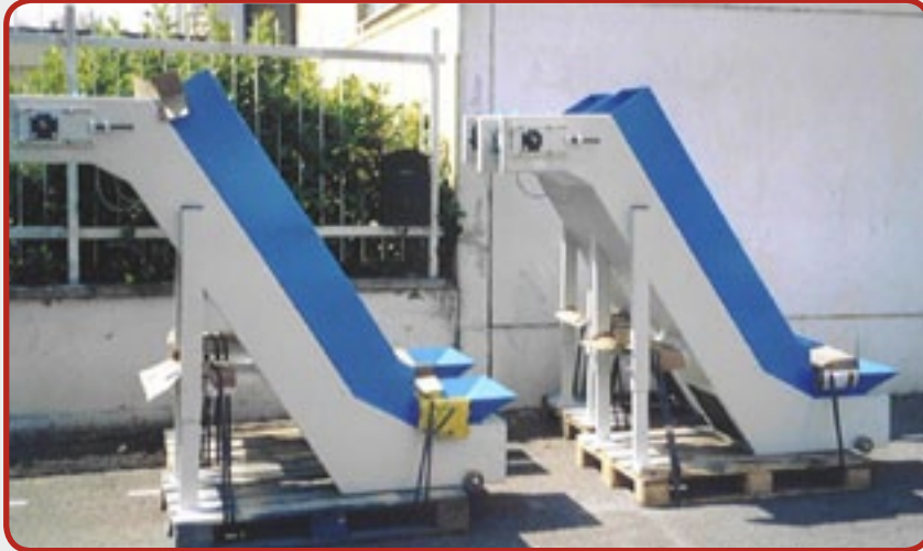
3. Geeignetes Förderband für Gießereien von Al-, Mg- und Zn-Legierungen (Abmessungen und Details nach Kundenanfrage).
