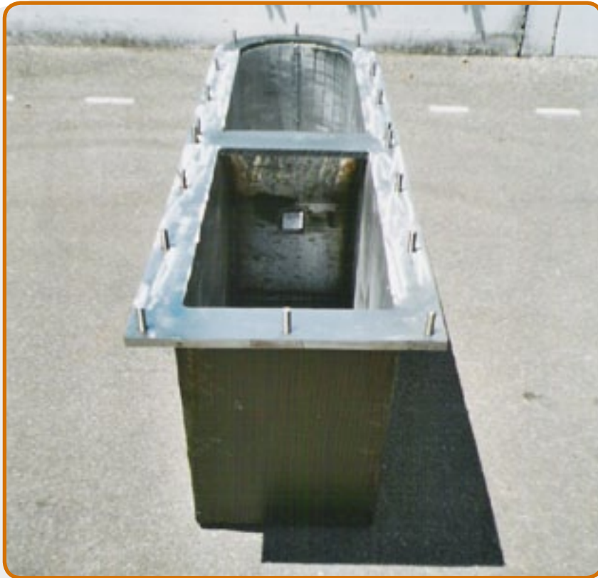
7. Schmelztiegel für Magnesiumlegierungen für den Warmkammer-Druckguss.
