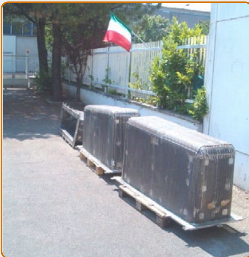
25. Creuset pour le recyclage des alliages de magnésium, capacité 1 tonne.
