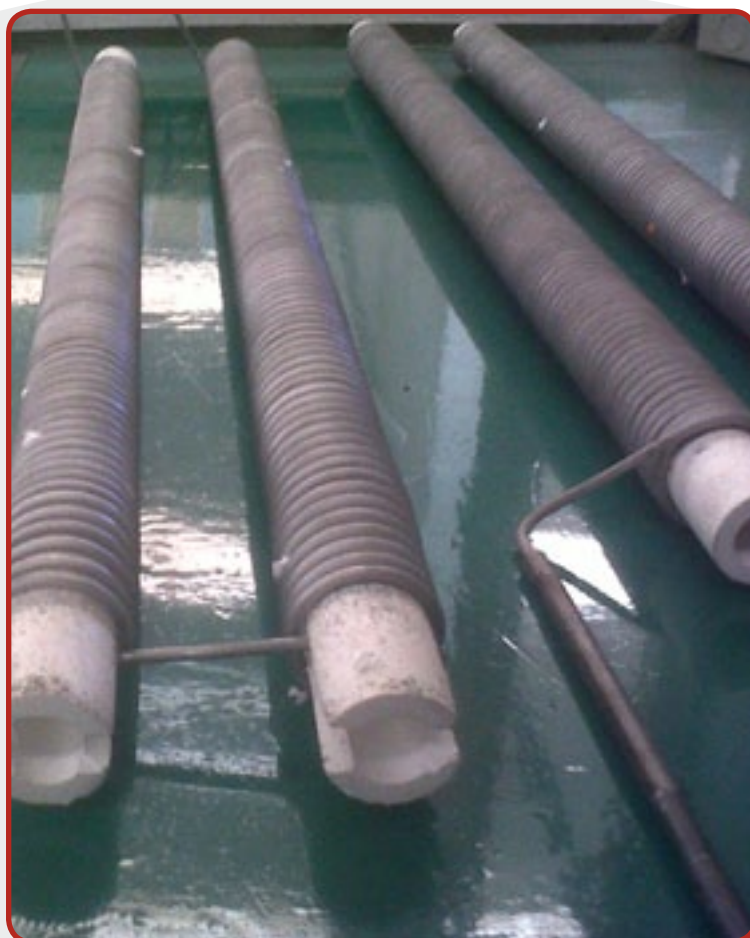
13. 缠绕在陶瓷支撑上的电阻。
