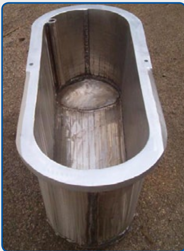
15. Creuset pour fonderie sous pression zinc, capacité de 380 kg.
