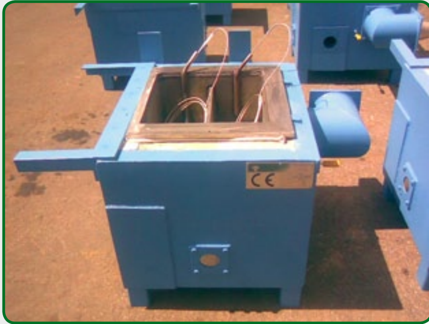
8- فرن ببيوتقة حوض مزدوج ، التدفئة بالغاز ، كاملة مع "أجهزة استشعار درجة حرارة .
