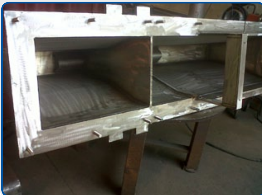
14. Schmelztiegel zum Umschmelzen von Zinklegierungen, Fassungsvermögen 2500 kg.
