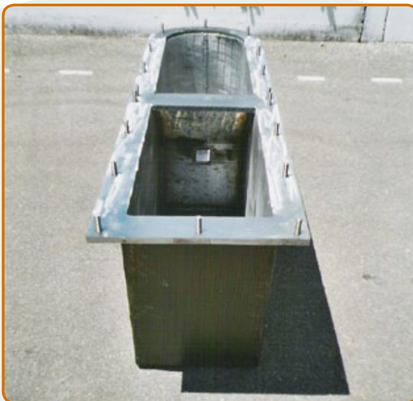
7. Creusets pour les alliages de magnésium pour coulée sous pression chambre chaude.
