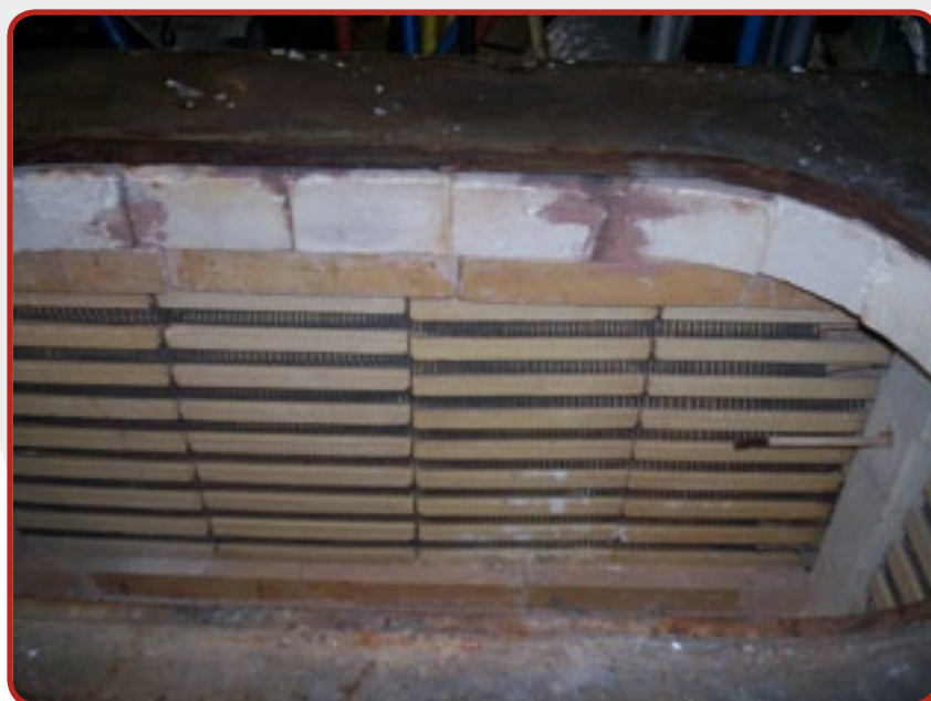
14. 在扁形电缆上的螺旋电阻。
