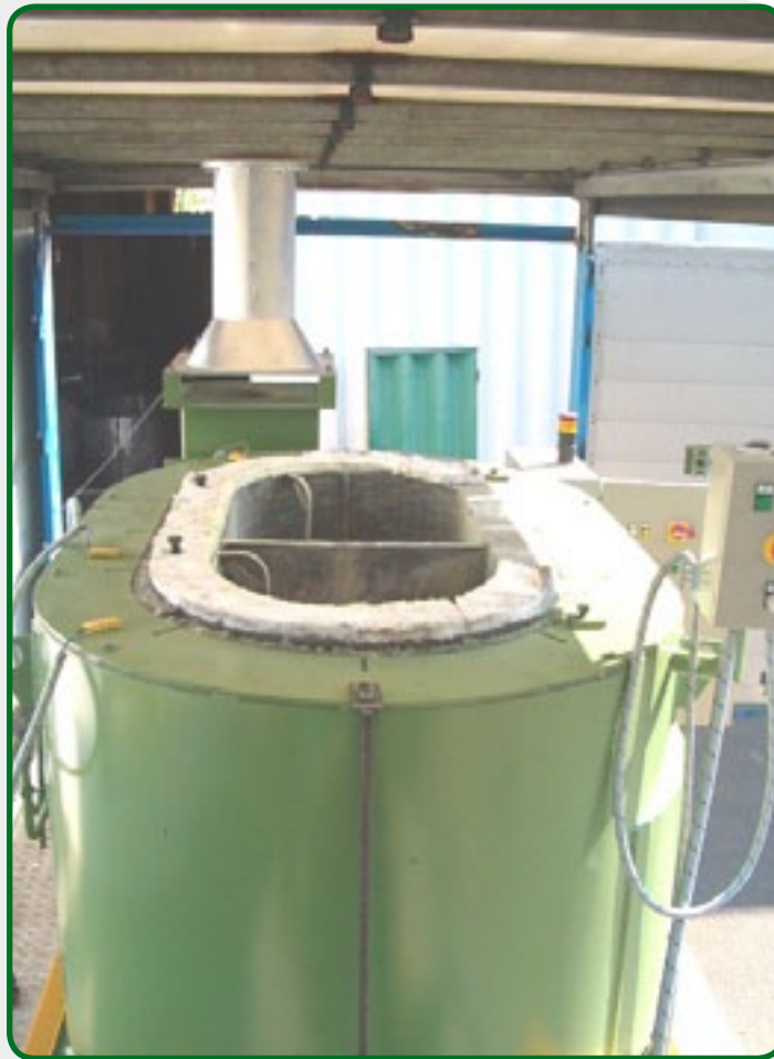
9. Tiegelofen mit Zweikammertiegel, für Mg, Fassungsvermögen 600 kg.
