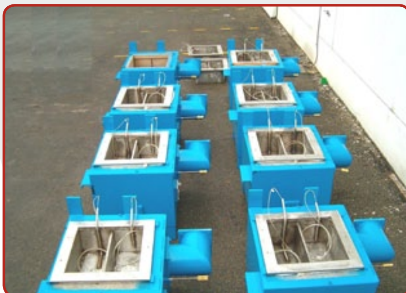
2. Fours zamac double chambre, complet de capteurs de température (dimensions et détails selon la demande du client).
