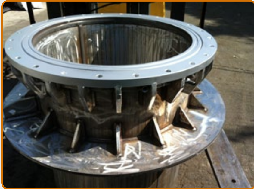
1. Schmelztiegel für Magnesiumlegierungen zum Niederdruck-Gießen.
