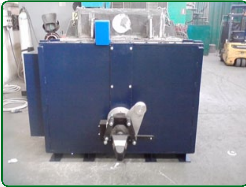
1. Tiegelofen, mit Gussventil, für Pb- / Zn-Legierungen.
