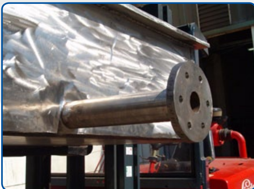
8. Crogiolo , capaità 10tonnellate di legeh di zinco, con valvola di scarico.
