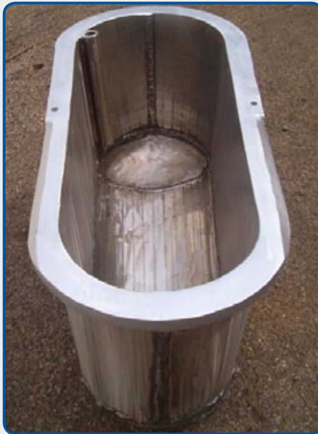
15. Schmelztiegel für den Druckguss von Zinklegierungen, Fassungsvermögen 380 kg.
