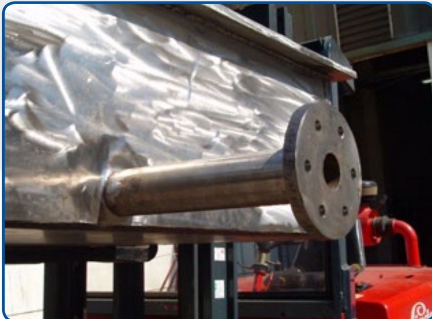
الزنك 8. بوتقة، قدرة 10 طن لسبائك الزنك مع صمام للتفريغ.
