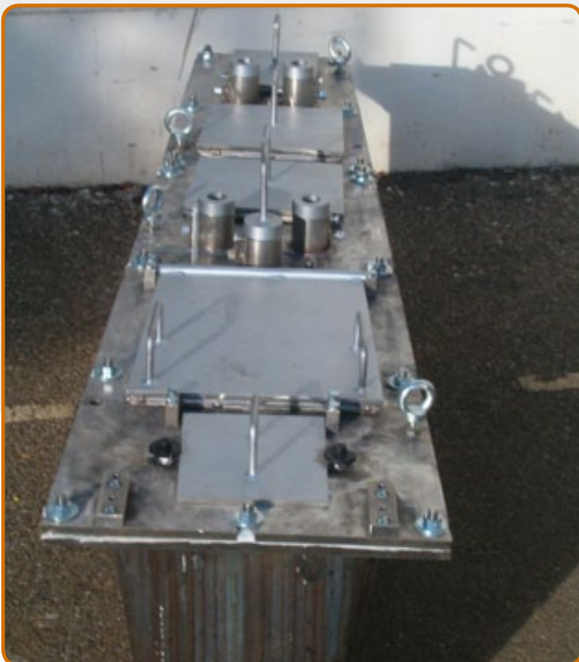
8. Crogioli per leghe di magnesio per la pressofusione a camera fredda
