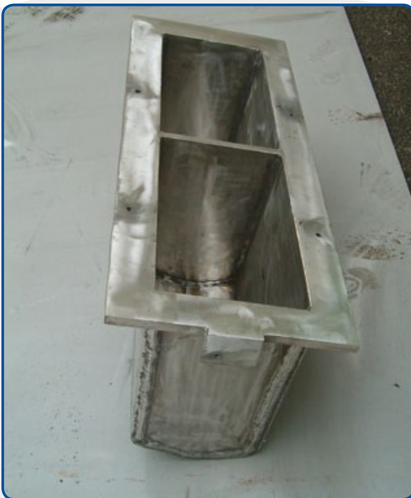
5. Тигель с двумя литниковыми чашами для литья под давлением цинковых сплавов.
