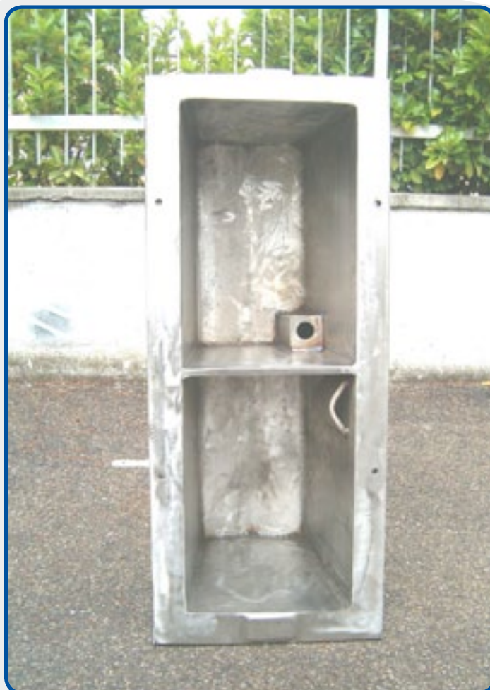
7. Crisol doble cámara para presión de fusión de aleaciones de cinc .
