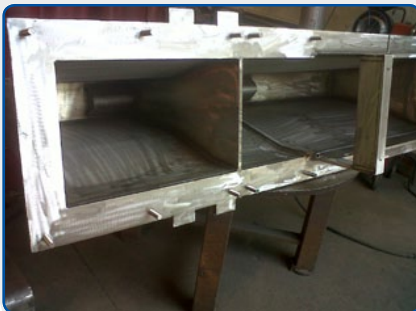
14. Refonte creuset pour les alliages de zinc, capacité de 2500 kg.
