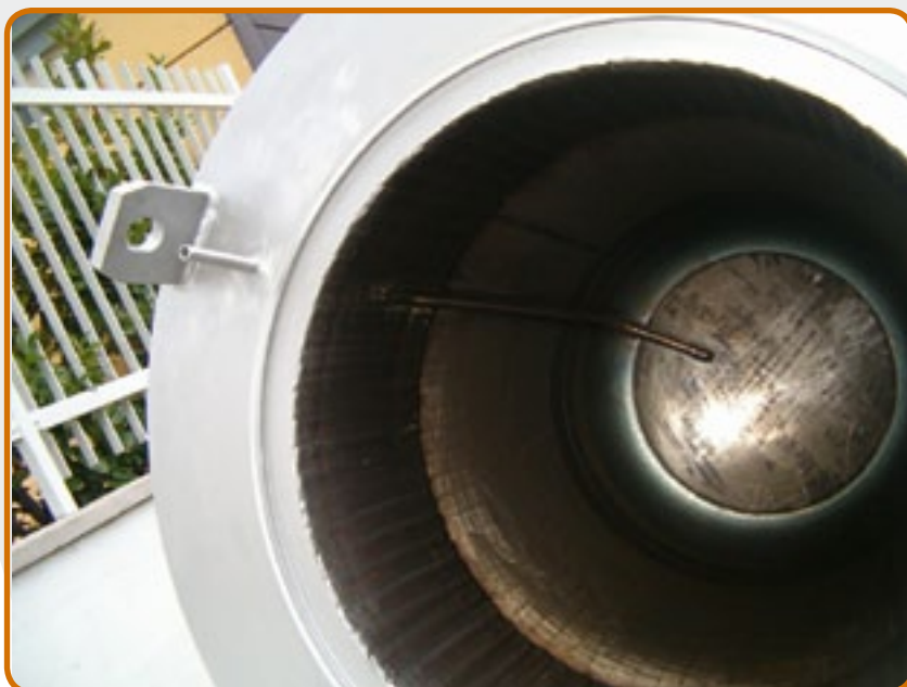
20. Тигель для выплавки магниевых сплавов под низким давлением.
