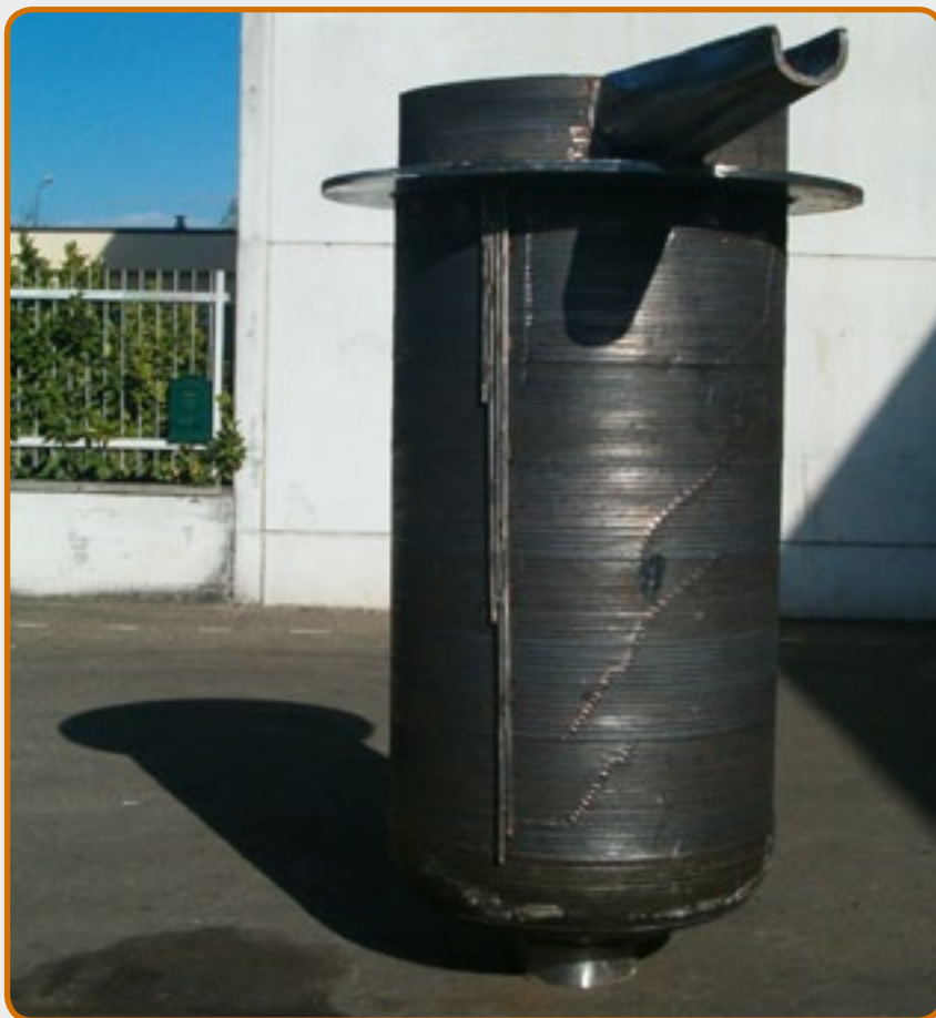
3. Crogiolo per riciclaggio delle leghe di magnesio.
