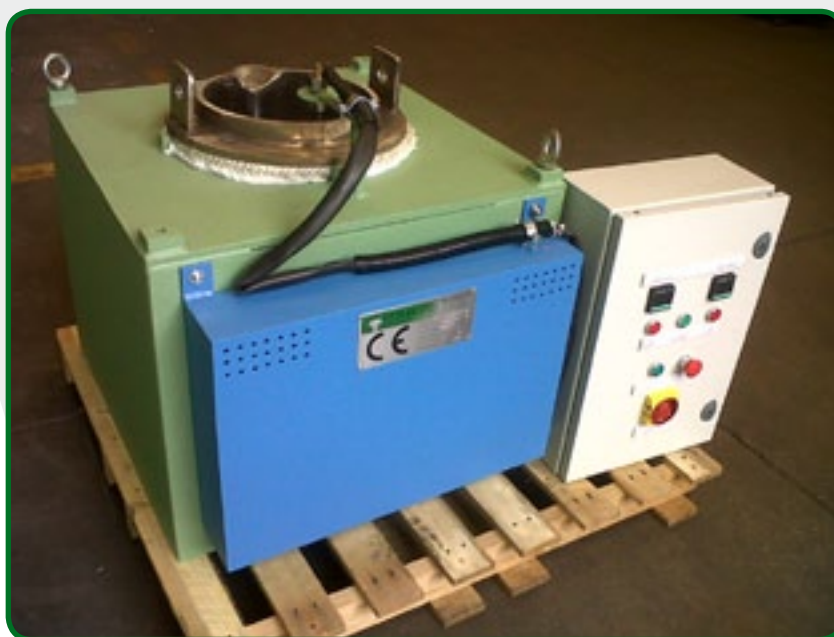
10. Ofen für Zn, elektrische Heizung.
