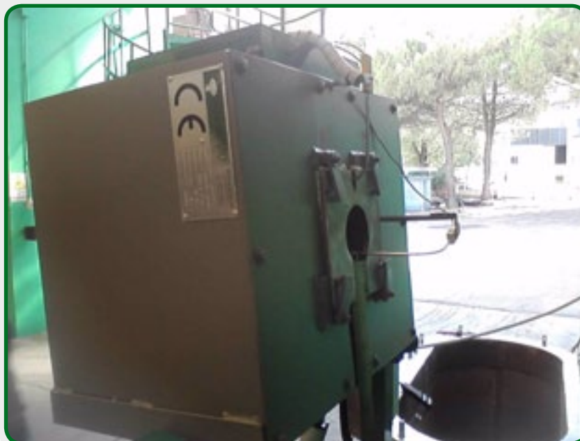
2. Horno reversible para aleaciones magnesium para la investigación.
