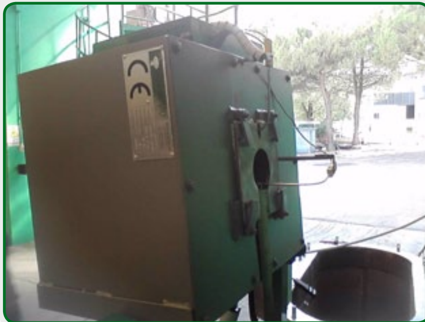
2. Kippbarer Ofen für Mg-Legierungen für Forschungslabore.
