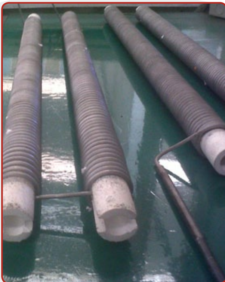
13. Elementos de calefacción eléctrica enrollados sobre soporte cerámico.
