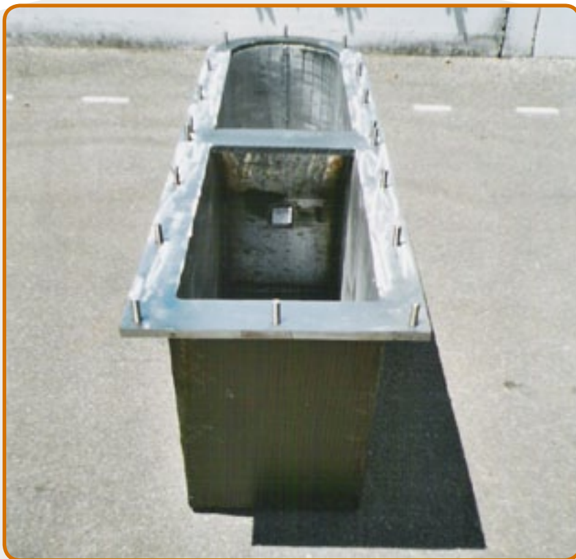
7. Crogioli per leghe di magnesio per la pressofusione a camera calda.
