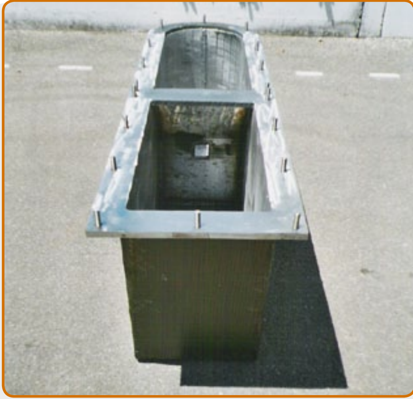
مغ 7. بوتقة لسبائك المغنيزيوم للاتصهار بواسطة الضغط داخل المخزن الساخنة
