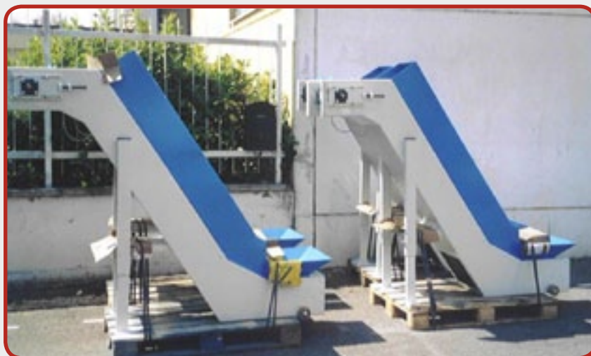
3. 铝、镁及锌合金铸造厂用的倾斜式传送带 (体积尺寸和细节可以根据客户的要求定制)。
