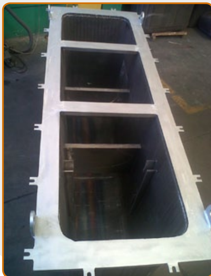
22. Creuset pour le recyclage des alliages de magnésium.
