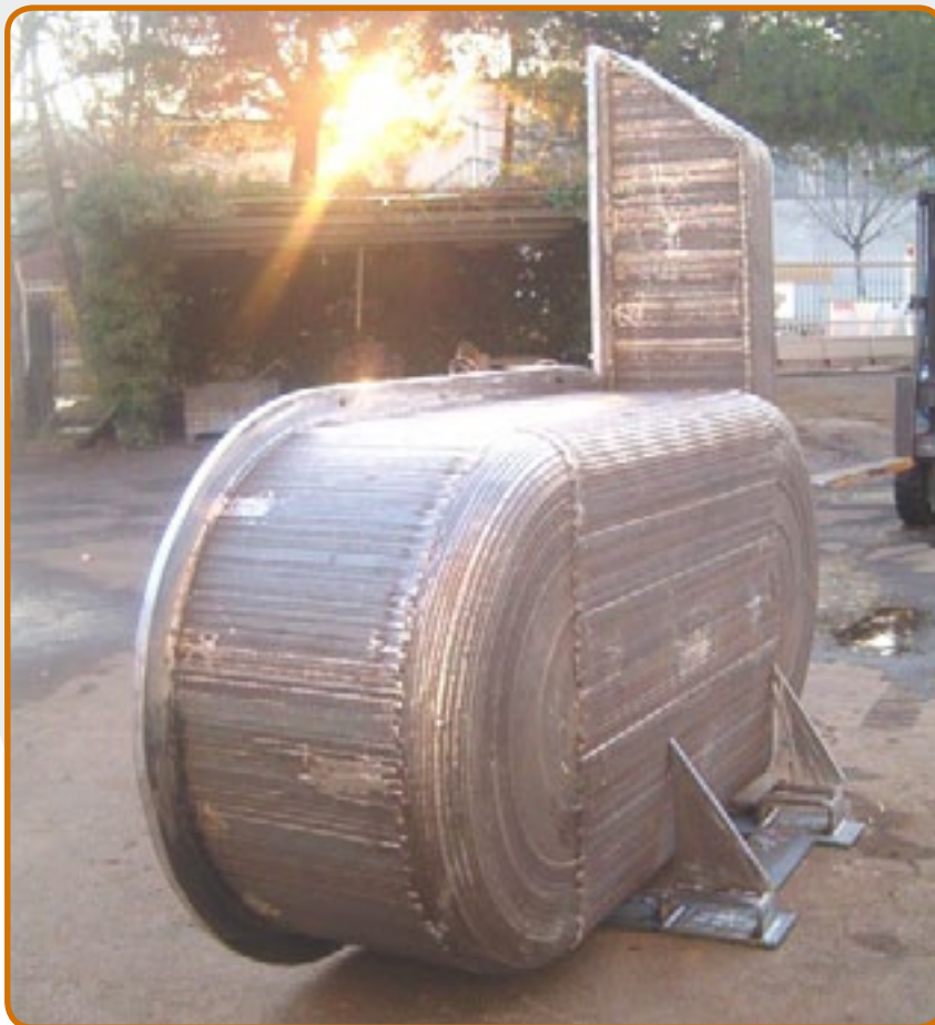
2. Schmelztiegel zum Umschmelzen von Magnesiumlegierungen.
