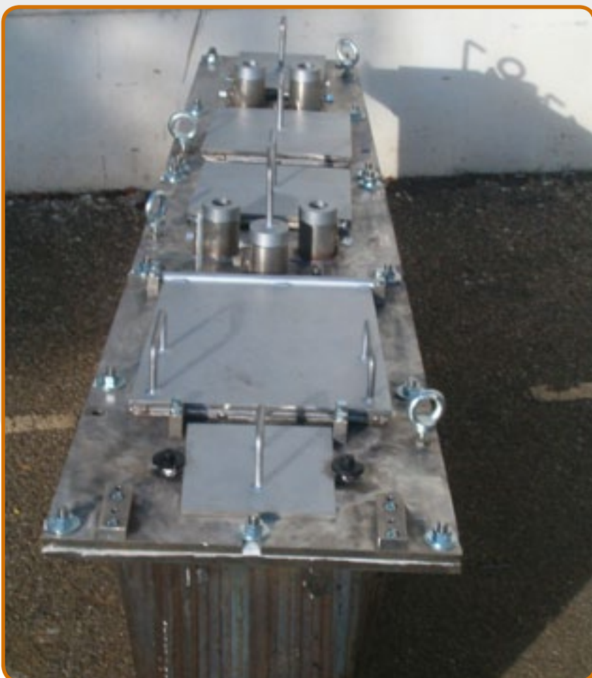
8. Crisoles para aleaciones de magnesio para presion de fusion de cámara fría.
