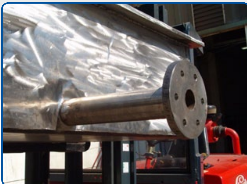
8. Тигель для цинковых сплавов, вместимостью 10 тонн, с выпускным клапаном.
