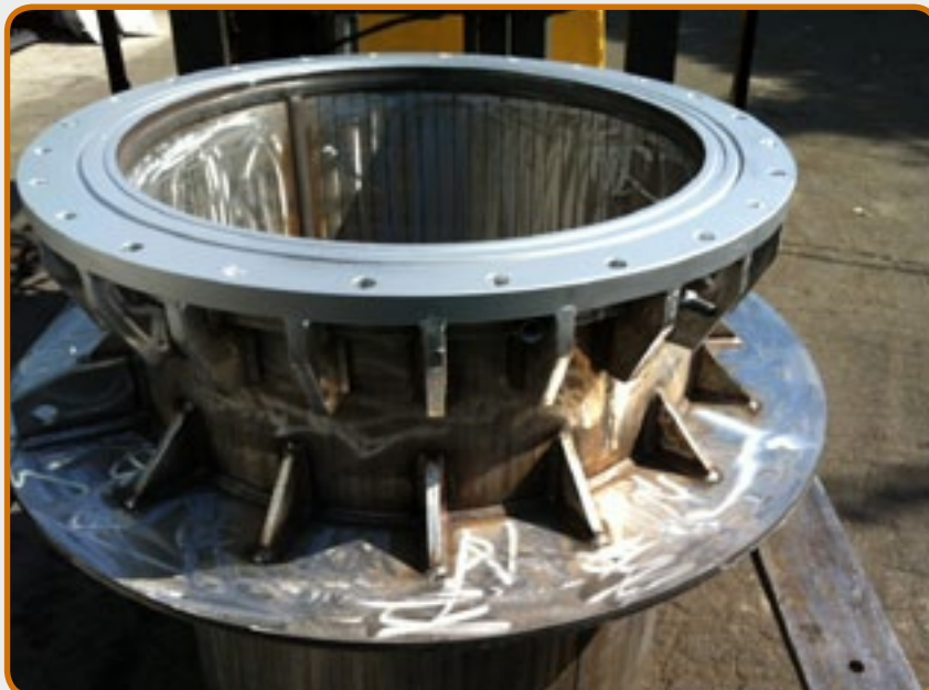
1. Creuset pour les alliages de magnésium pour la fusion basse pression.
