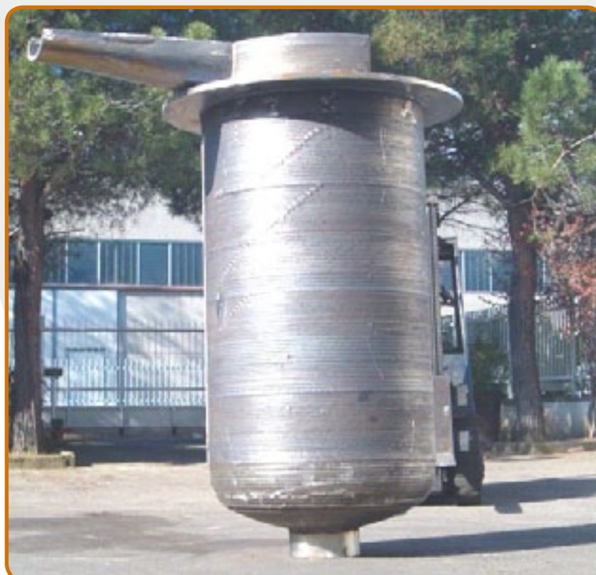
6. Crisol para el reciclado de las aleaciones de magnesio.
