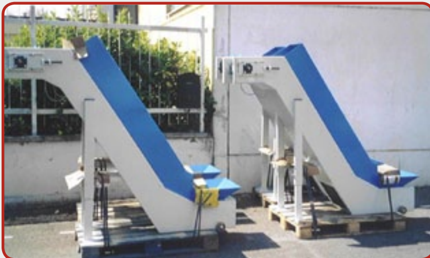
3. Nastro trasportatore inclinato per fonderie di leghe di Al, Mg e Zn (misure d'ingombro e dettagli secondo richiesta del Cliente).
