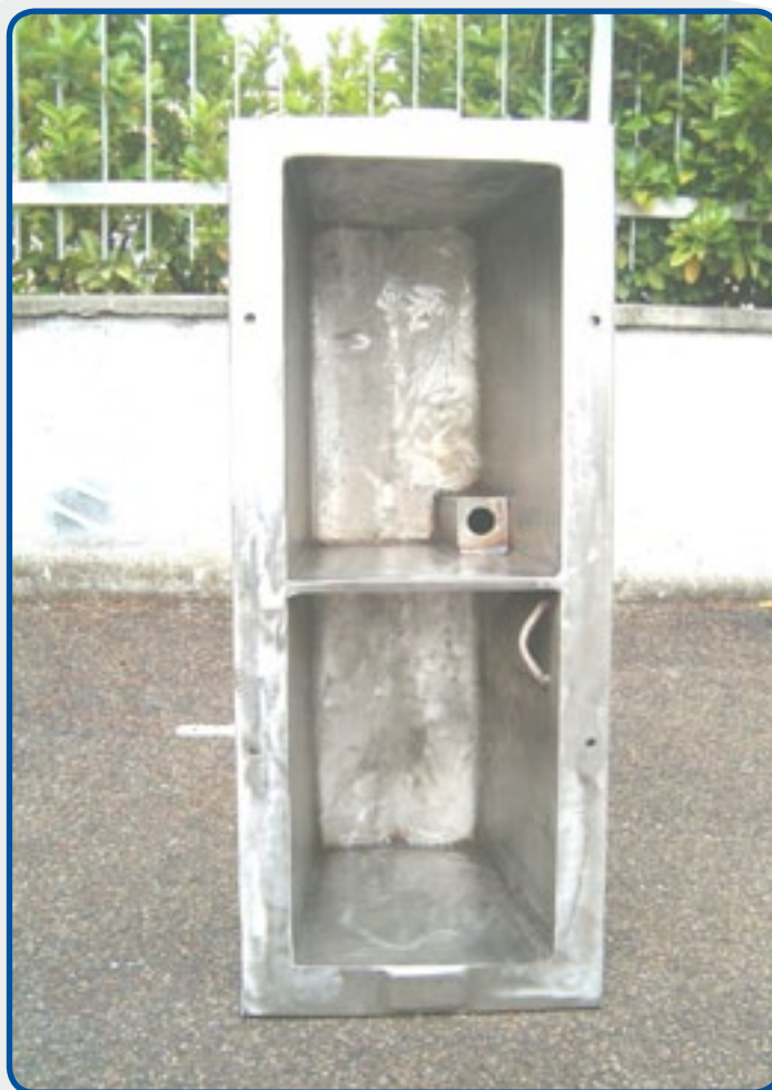
7. Тигель с двумя литниковыми чашами для литья под давлением цинковых сплавов.
