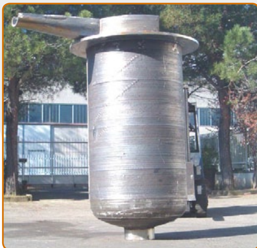
6. Тигель для переработки магниевых сплавов.
