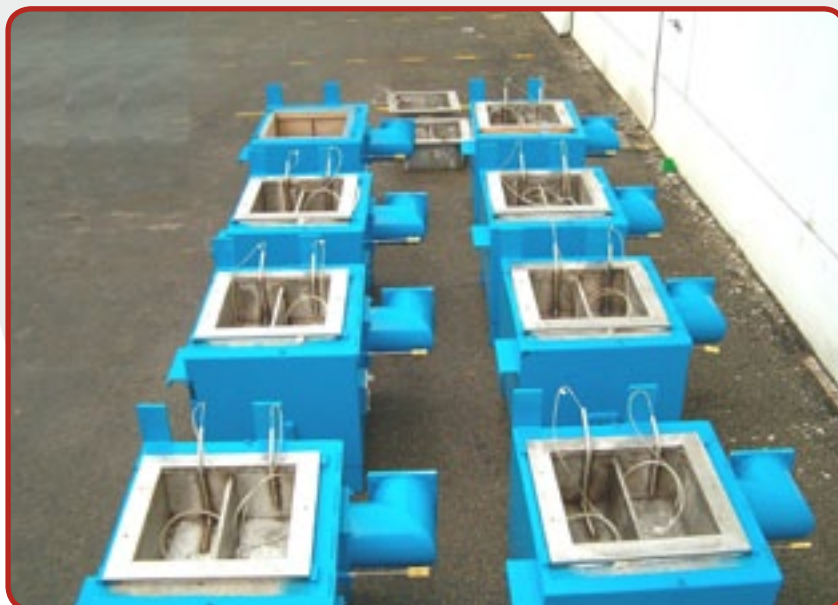
2. Установка с двумя литниковыми чашами, полностью укомплектованная, с датчиками температуры (габаритные размеры и прочие детали в соответствии с запросом клиента) .
