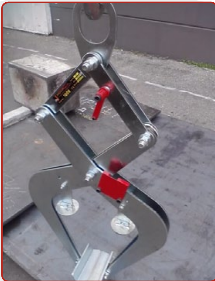
5. Klemme mit doppeltem Pantograph für den Barrentransport, mit selbstsperrenden Sicherheitsvorrichtungen.
