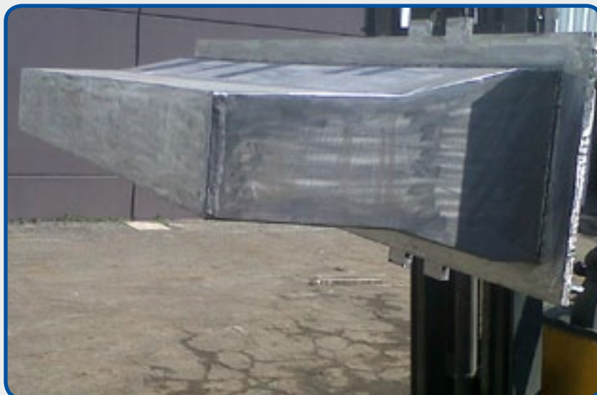
13. Crisoles para la refundición de las aleaciones de cinc.
