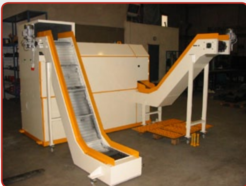
4. Установка звукоизолированная, полностью укомплектованная, с системой сепарации и с двумя ленточными транспортёрами (габаритные размеры и прочие детали в соответствии с запросом клиента) .
