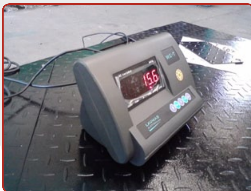
10. Цифровая панель управления весами.
