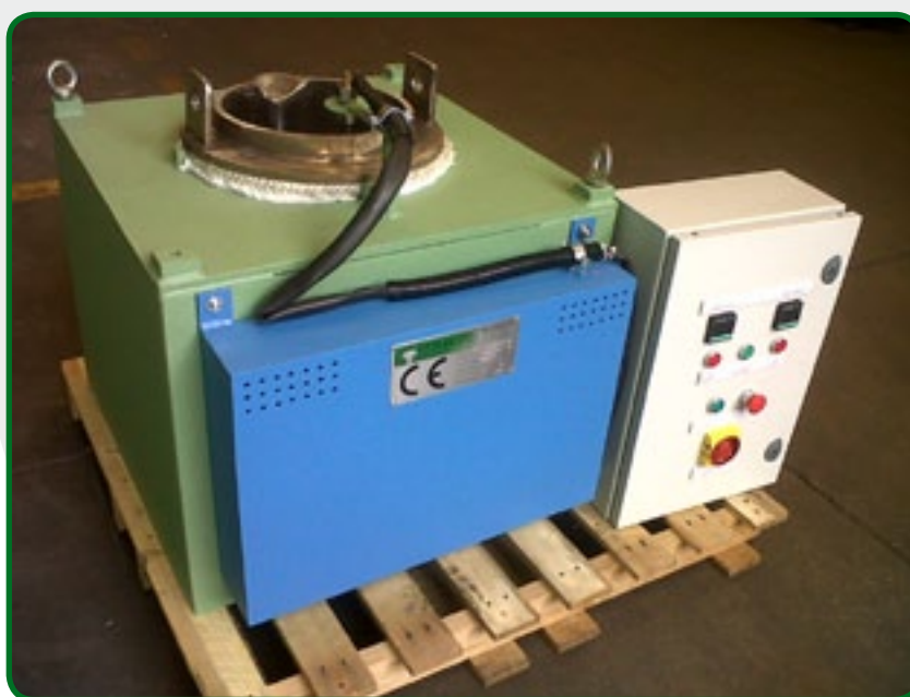
10. Forno per zn, riscaldamento elettrico.
