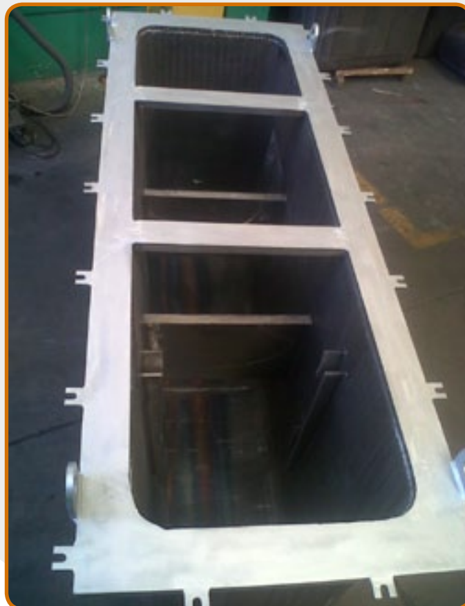
22. Schmelztiegel für die Wiederverwertung von Magnesiumlegierungen.
