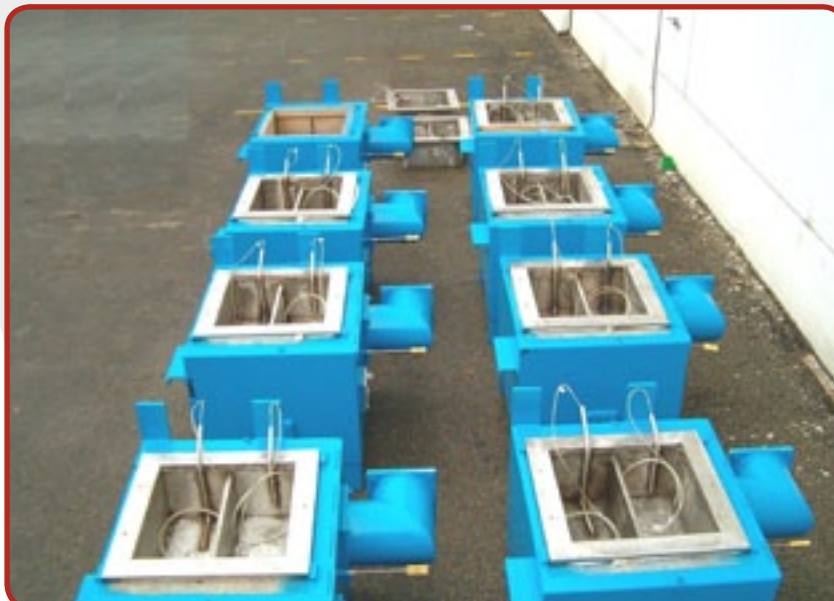
2. Anlage mit Zweikammertiegel und Temperatursensoren (Abmessungen und Details nach Kundenanfrage).
