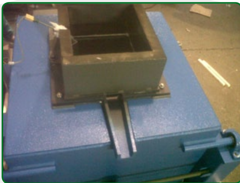
5. Kippbarer Ofen, Fassungsvermögen Pb / Zn 500 kg.
