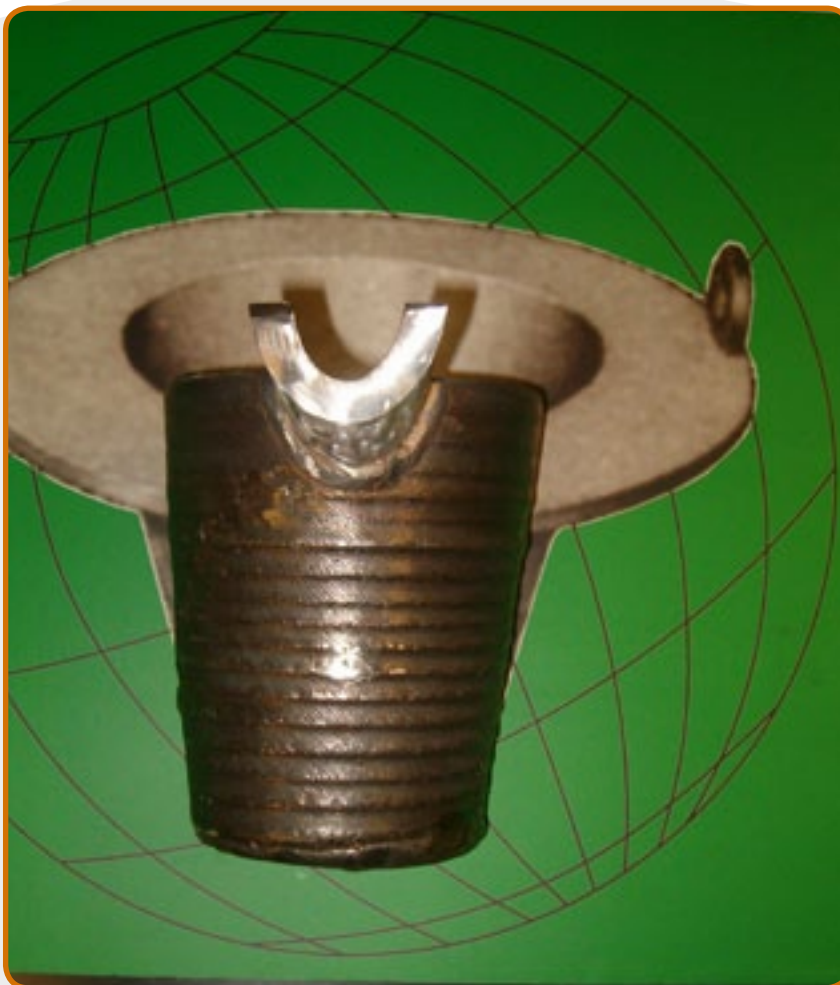
5. Crisoles para aleaciones de magnesio para la investigación y de laboratorio.
