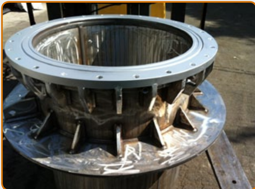
1. Crisol para aleaciones de magnesio para la fundición de baja presión.
