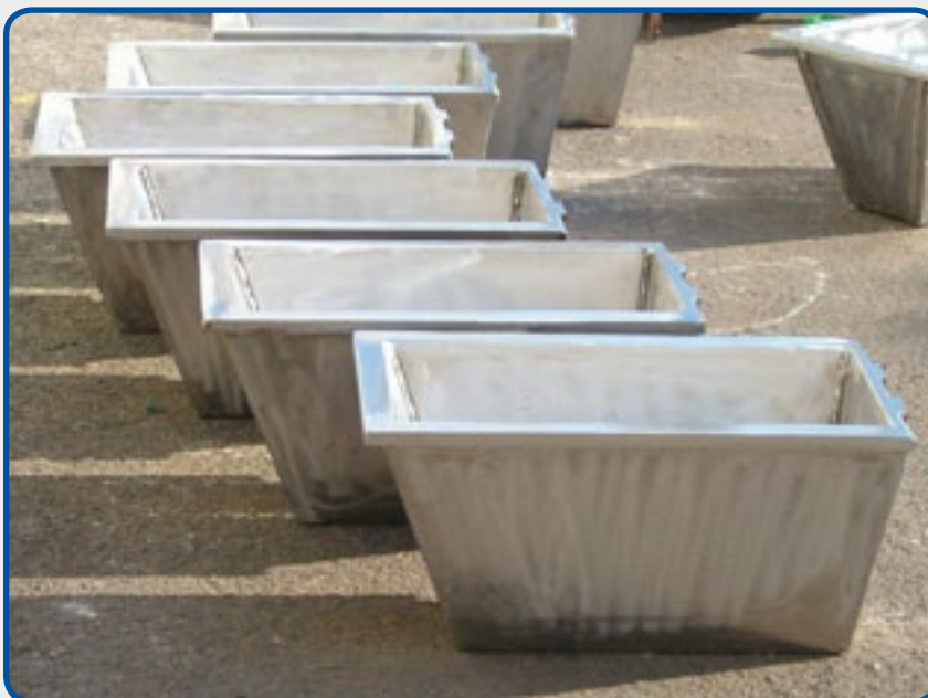
3. L'utilisation de creusets pour le plomb dans les machines pour le zinc (conversion).
