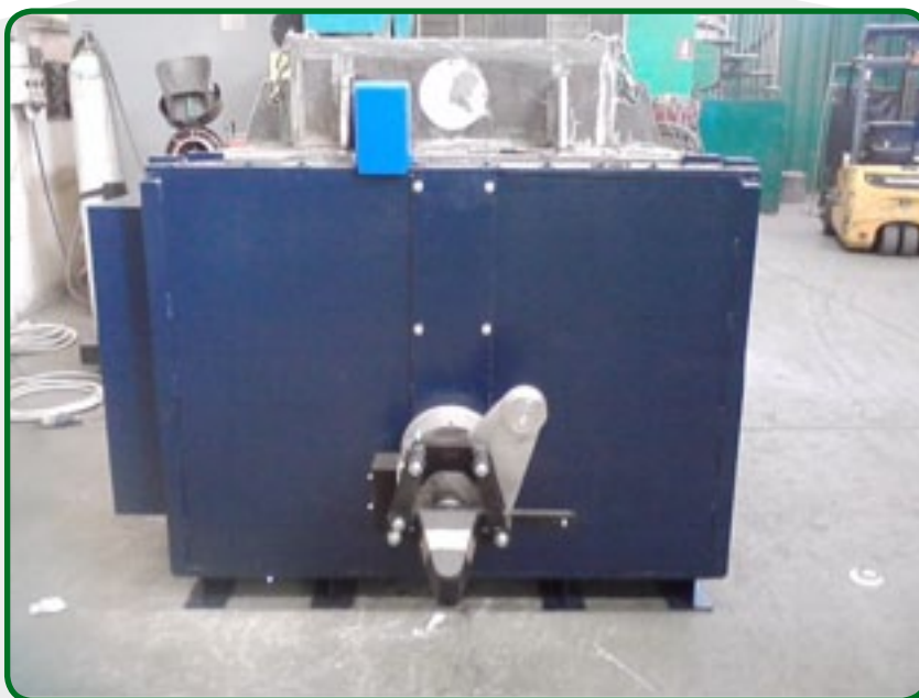
1. Forno a crogiolo, con valvola di colata, per leghe di pb / zn.
