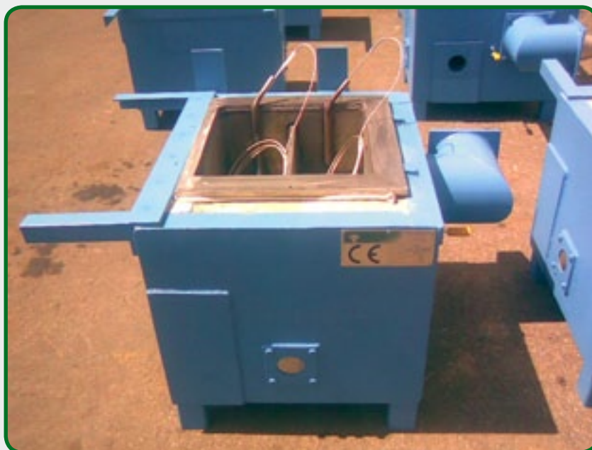
8. Horno con el crisol, doble cámara, calefacción de gas con sensores de temperatura.
