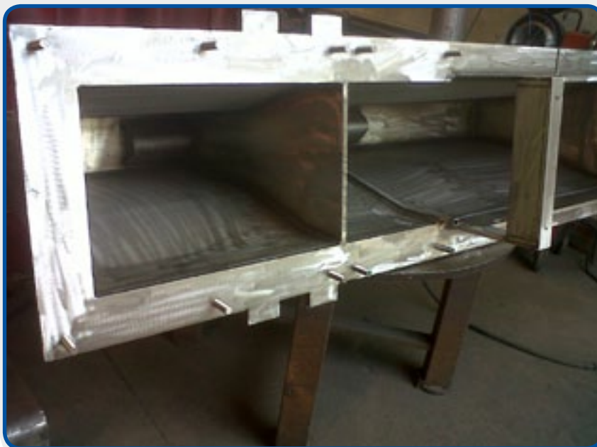
14. Crogiolo di rifusione per leghe di zinco, capacità 2500 KG.
