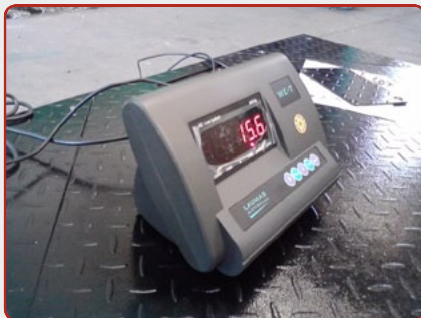
10. Pannello digitale di controllo per bilancia.
