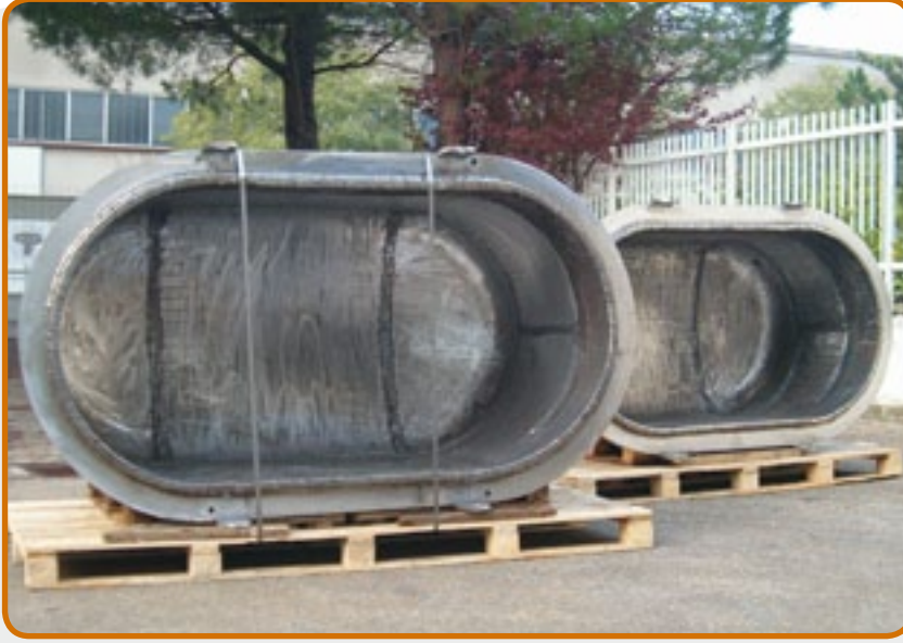
مغ 11. طلاء للحماية الداخلية ضد التآكل لغاز sf6 .
