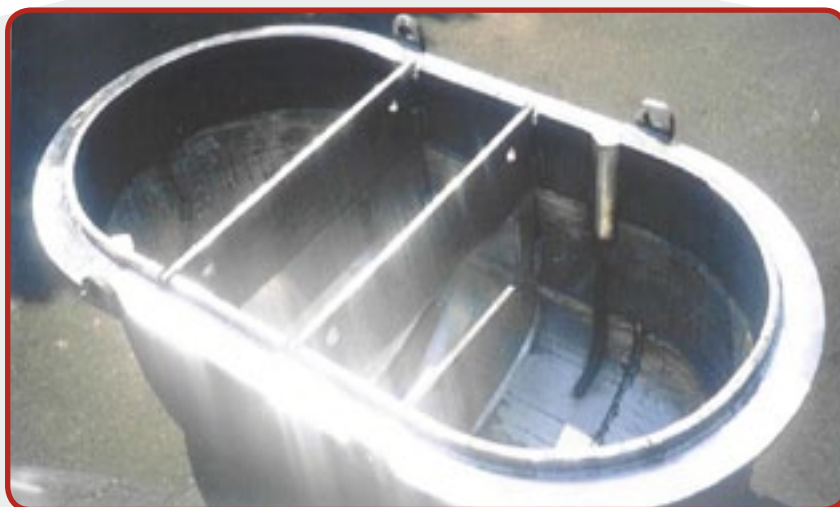
17. Doppia paratia sfilabile e tasca porta termocoppia per crogioli per pressofusione (misure d'ingombro e dettagli secondo richiesta del Cliente).
