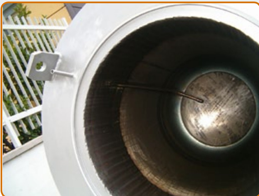
20. Creuset pour la fusion d'alliages de magnésium à basse pression.
