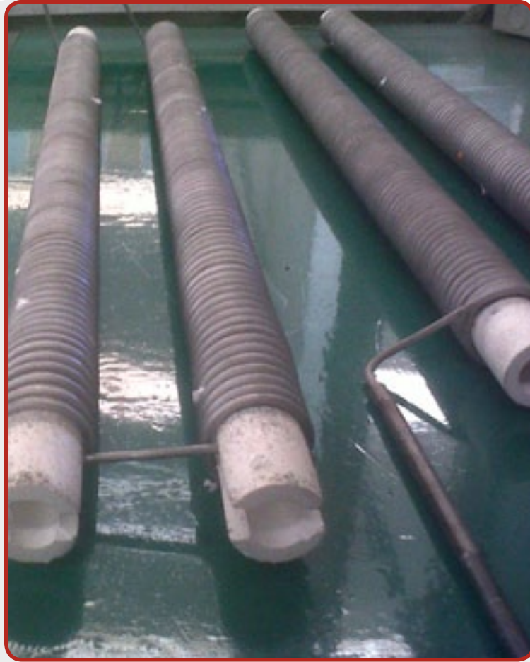
13-مقاومة كهربائية احيانا على داعم من السيراميك
