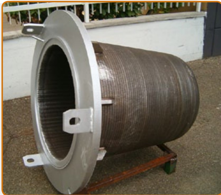
17. Тигель для литья без применения давления, вместимость 500 кг.
