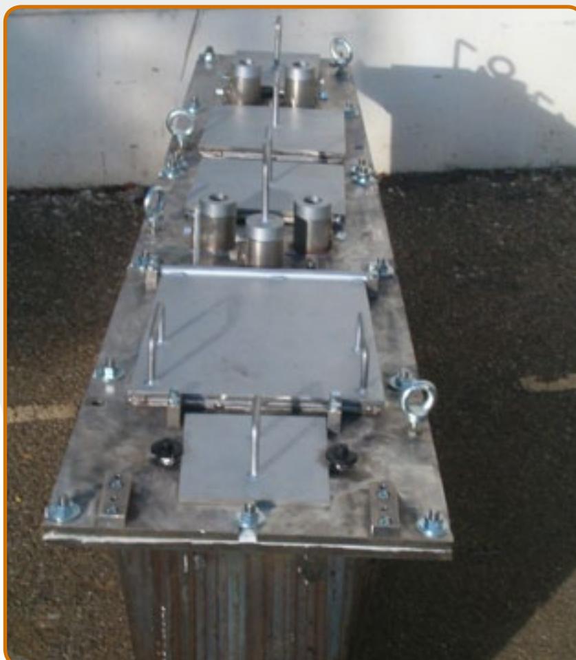
8. Creusets pour les alliages de magnésium pour chambre froide
