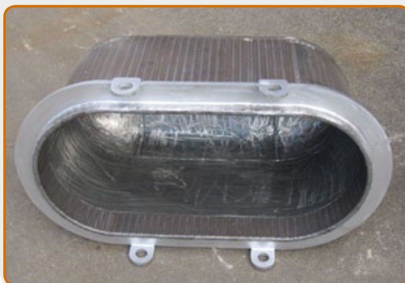
24. Creuset pour les alliages de magnésium, de capacité de 4 tonnes.
