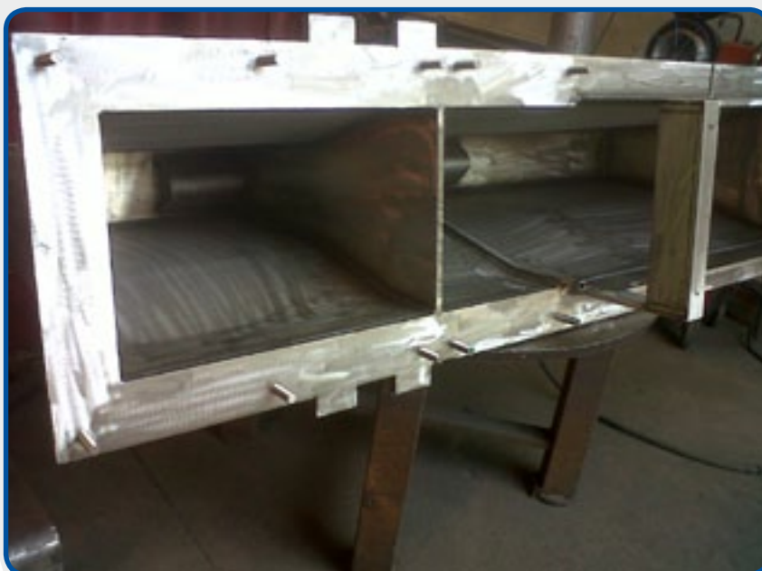
14. Crisol para refundición por aleaciones de cinc, capacidad 2.500 kg.
