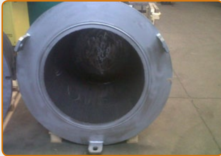
13. Schmelztiegel für den Kokillenguss, Fassungsvermögen 500 kg.
