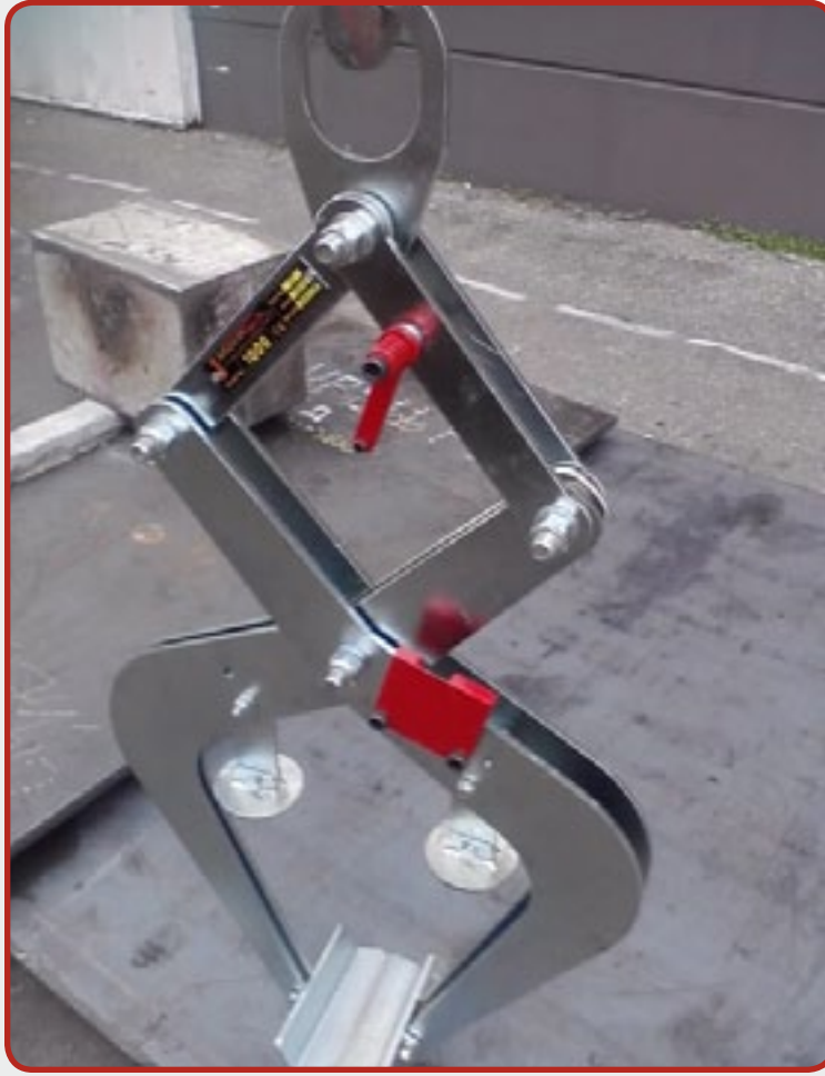
5- ملقط دا منسخ مزدوج لتحميل السبائك، مجهز بالتحكم الذاتي لرفع الوزن (الأبعاد والتفاصيل وفقا لطلب العميل).
