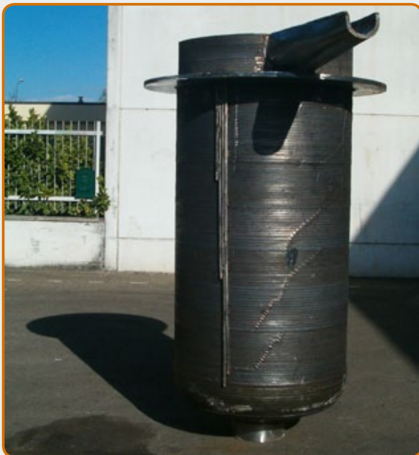
3. Creuset pour le recyclage des alliages de magnésium.
