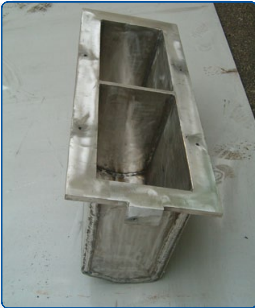
5. Schmelztiegel mit zwei Kammern für den Druckguss von Zinklegierungen.
