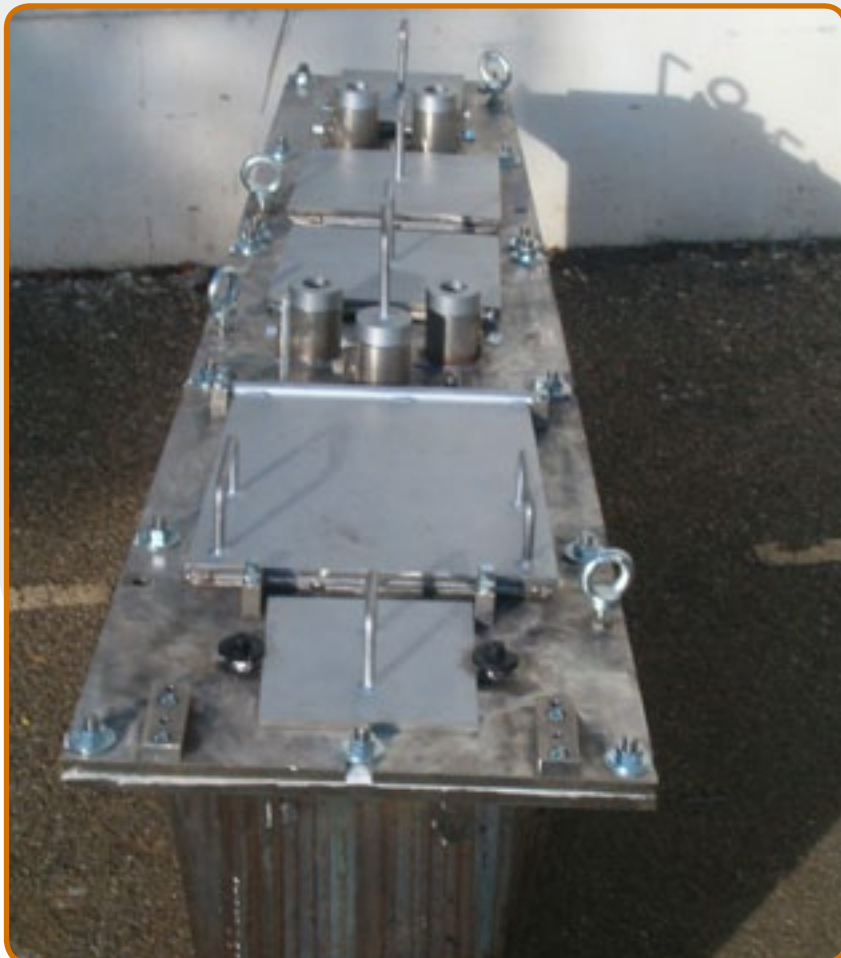
8. Schmelztiegel für Magnesiumlegierungen für den Kaltkammer-Druckguss.
