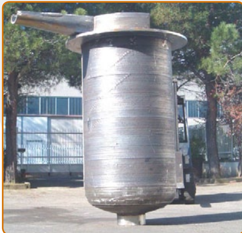
6. Schmelztiegel für die Wiederverwertung von Magnesiumlegierungen
