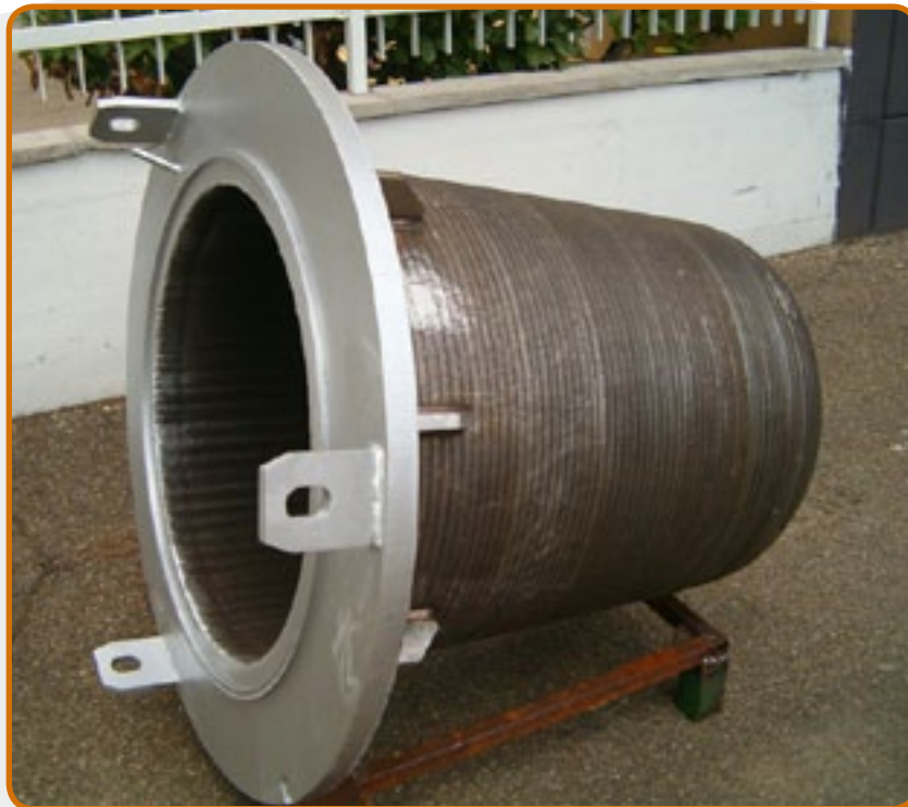
17. Schmelztiegel für den Kokillenguss, Fassungsvermögen 500 kg.
