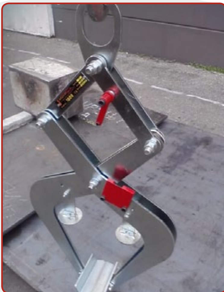
5. Pinza a doppio pantografo per carico lingotti, dotata di sicurezze autobloccanti per sollevamento.
