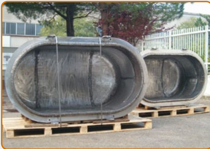
11. Футеровка защитная внутренняя, защита от коррозионного воздействия газов SF 6 .
