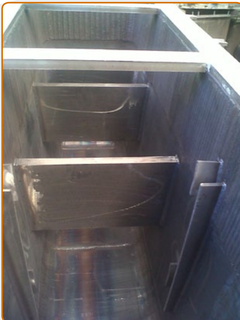
9. Crisoles para el reciclado de las aleaciones de magnesio, capacidad de 2,2 toneladas.
