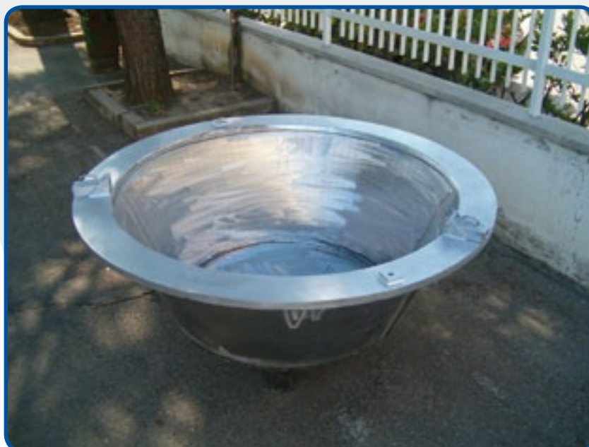
6. Crisoles para la refundición y refinación de aleaciones de cinc.
