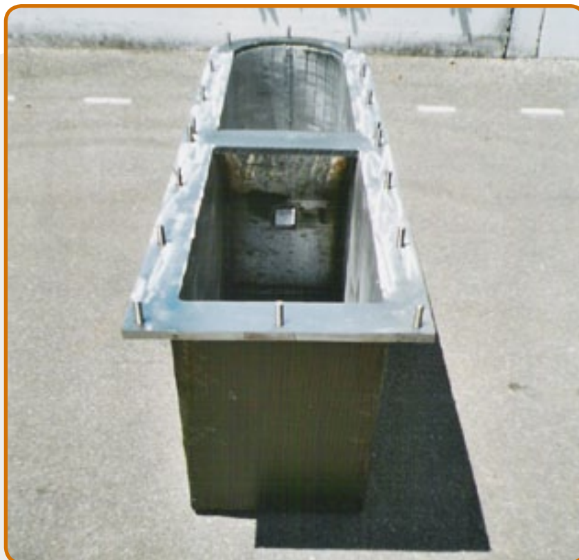
7. Тигли для переработки магниевых сплавов литьём под давлением с горячей камерой прессования.
