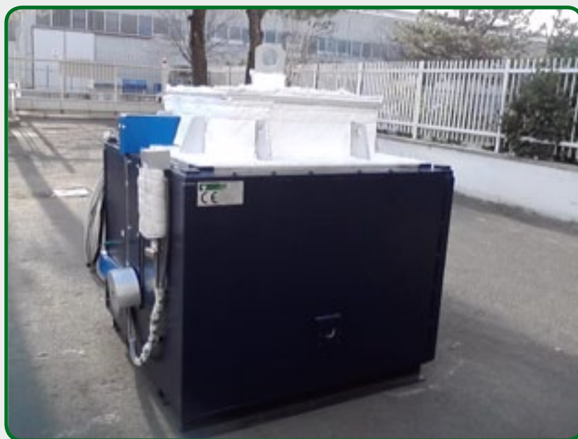
4. Forno, capacità zn 6000 – 7000 kg.
