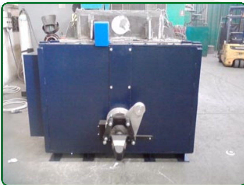
1. Horno de crisol con valvula de fusion para aleaciones pb / zn .
