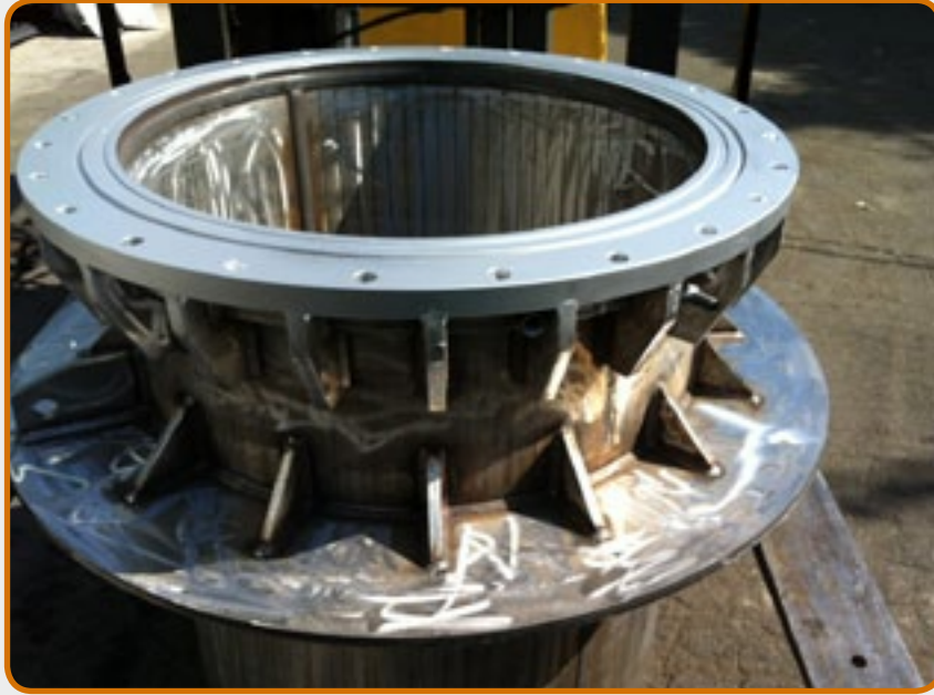
مغ 1. بوتقة لسمائك المغنيزيوم للانصهار تحت الضغط المنخفض
