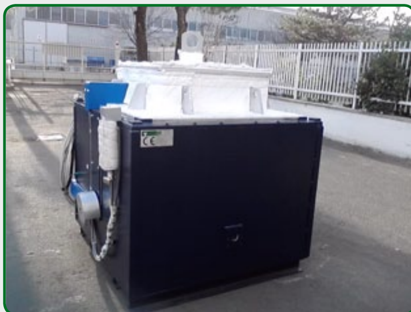
4. Capacidad del horno 6000 - 7000 kg. de cinc.
