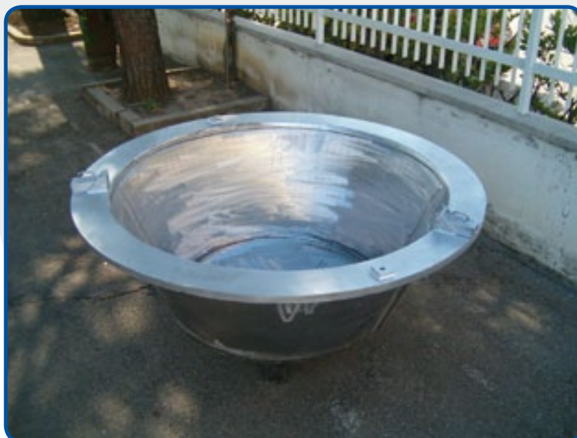
6. Creusets pour la refusion et l'affinage des alliages de zinc.
