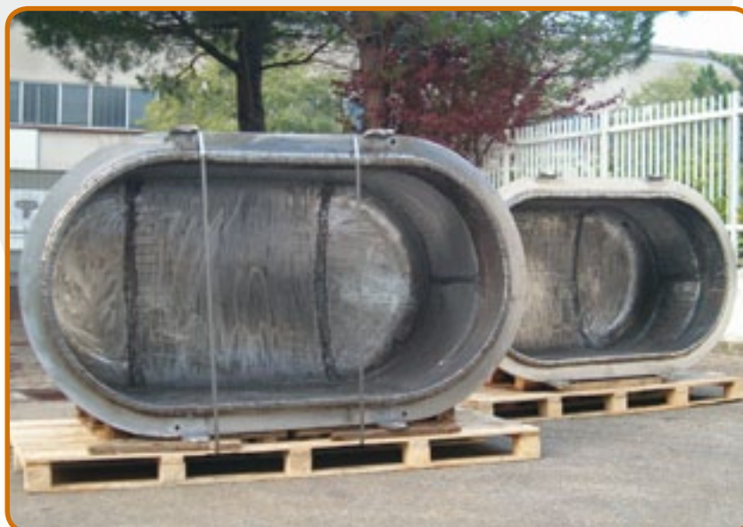
10. Crisoles mg para el reciclaje de aleaciones de magnesio, capacidad de 7 toneladas.
