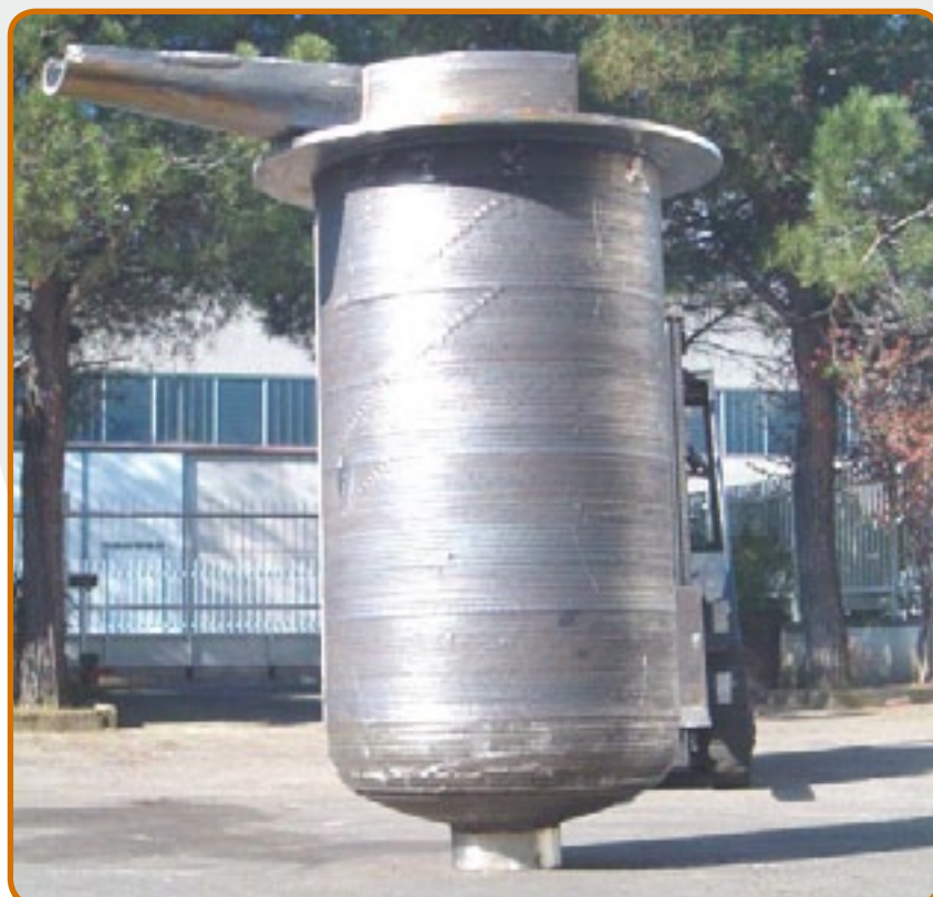
6. Crogiolo per riciclaggio delle leghe di magnesio.
