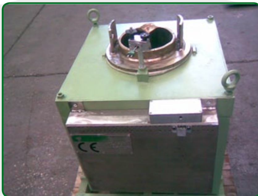
3. Horno de crisol para las aleaciones de cinc.
