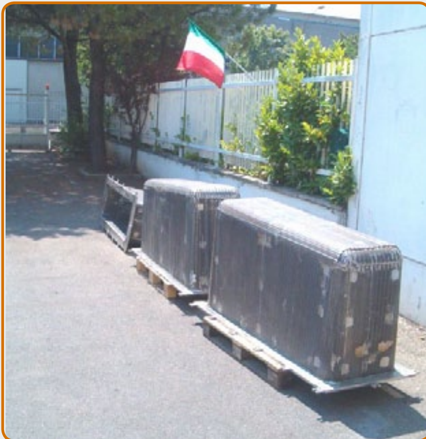
25. Тигли для переработки магниевых сплавов, вместимость 1 тонна.
