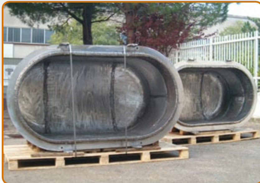
مغ 10. بوتقة لإعادة التدوير لسبائك المغنسيوم ، قدرة 7 طن
