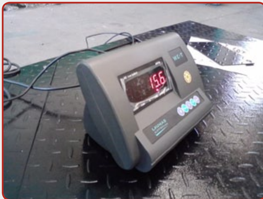
10. Digitales Bedienfeld für Waagen.
