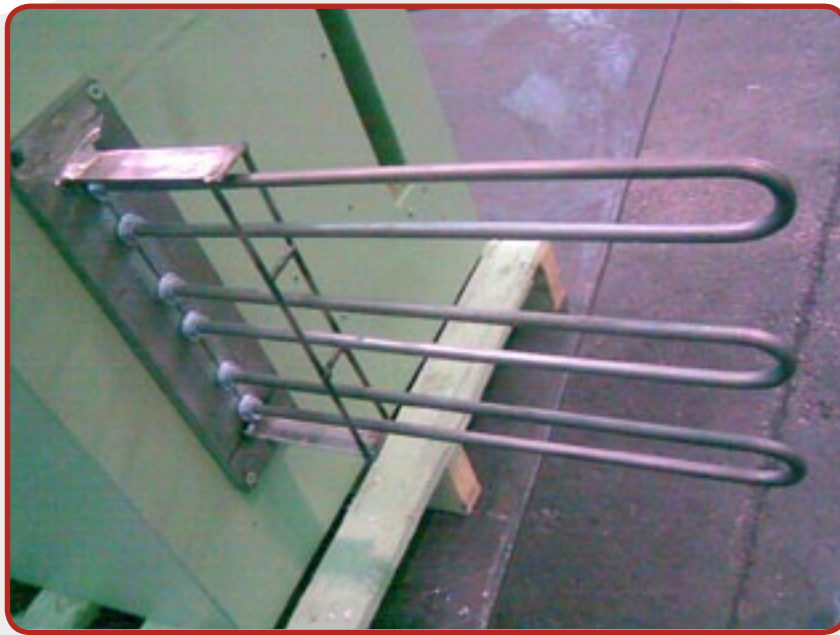
15. Gepanzerte elektrische Heizelemente.
