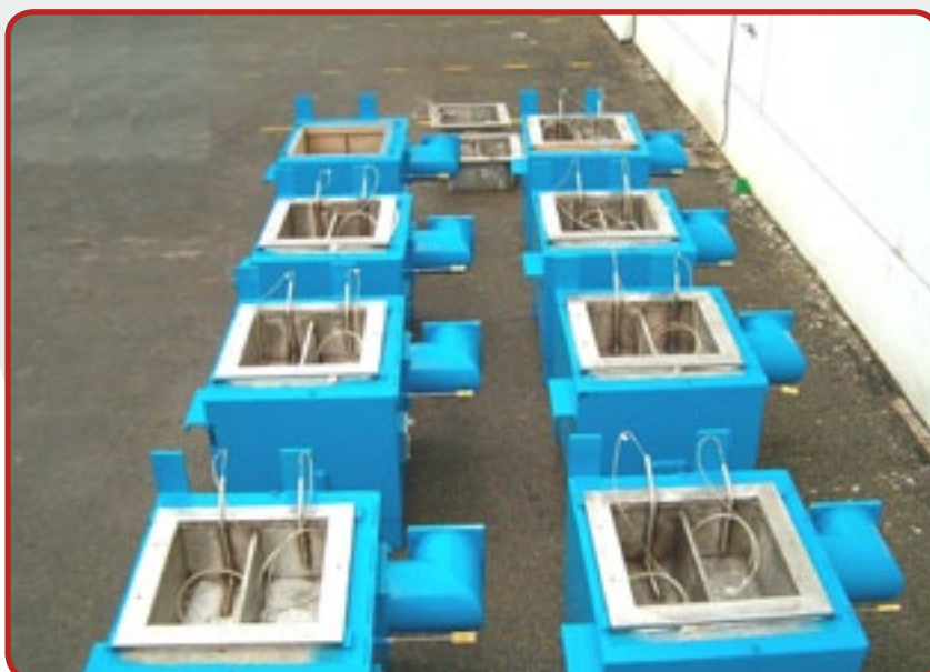
2. Horno con el crisol, doble cámara, con sensores de temperatura (dimensiones y detalles según l'aplicación del cliente).
