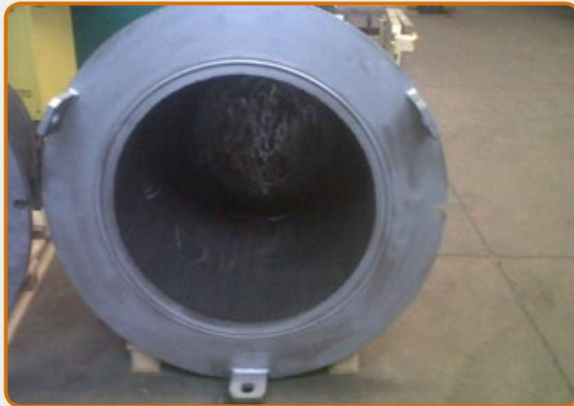
13. Тигель для литья без применения давления, вместимость 500 кг.
