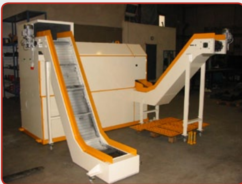
4. Impianto insonorizzato, completo di separazione e con aggiunta di due nastri trasportatori (misure d'ingombro e dettagli secondo richiesta del Cliente).
