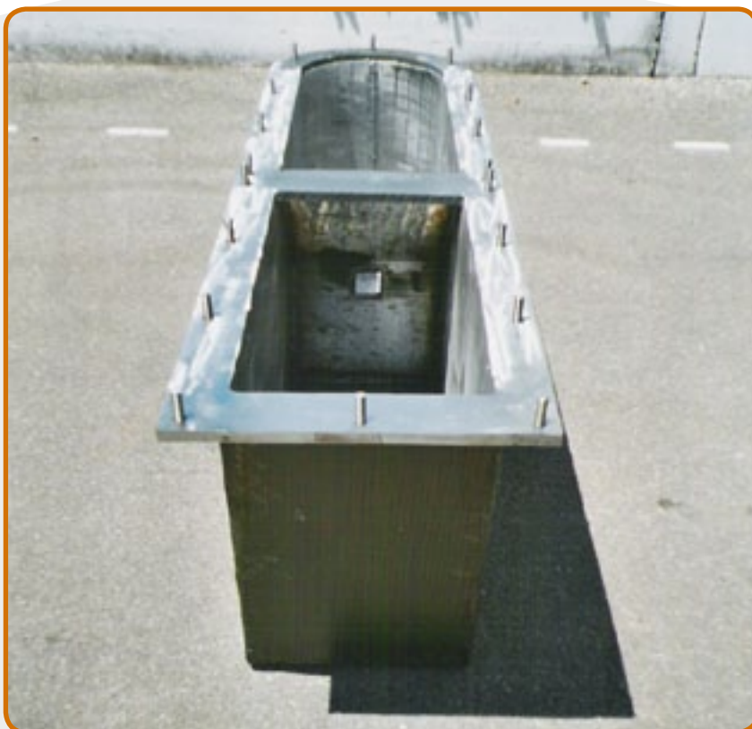
7. Crisoles para aleaciones de magnesio para presion de fusion en cámara caliente.
