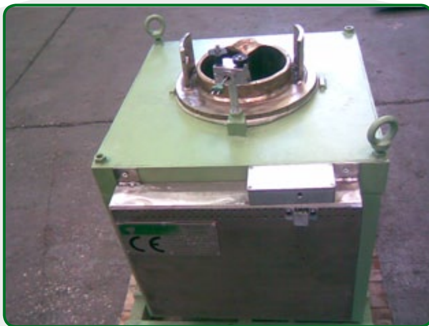
3. Four à creuset pour les alliages ZN.
