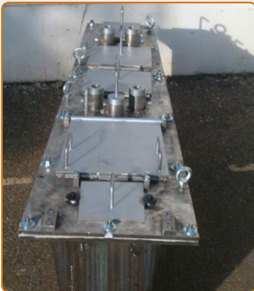
8. Тигли для переработки магниевых сплавов литьём под давлением с холодной камерой прессования.
