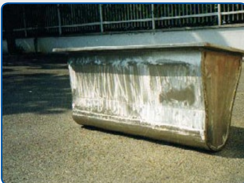
16. Refundición Crisol para aleaciones de cinc, capacidad 2.500 kg.
