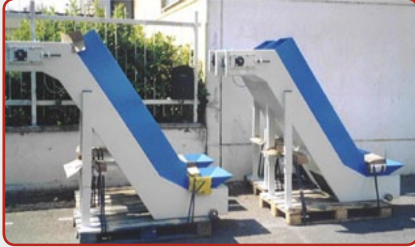
3- الحزام الناقل المائل لمسبك سباتك MG, AI, ZN (الأبعاد والتفاصيل وفقا لطلب العميل)
