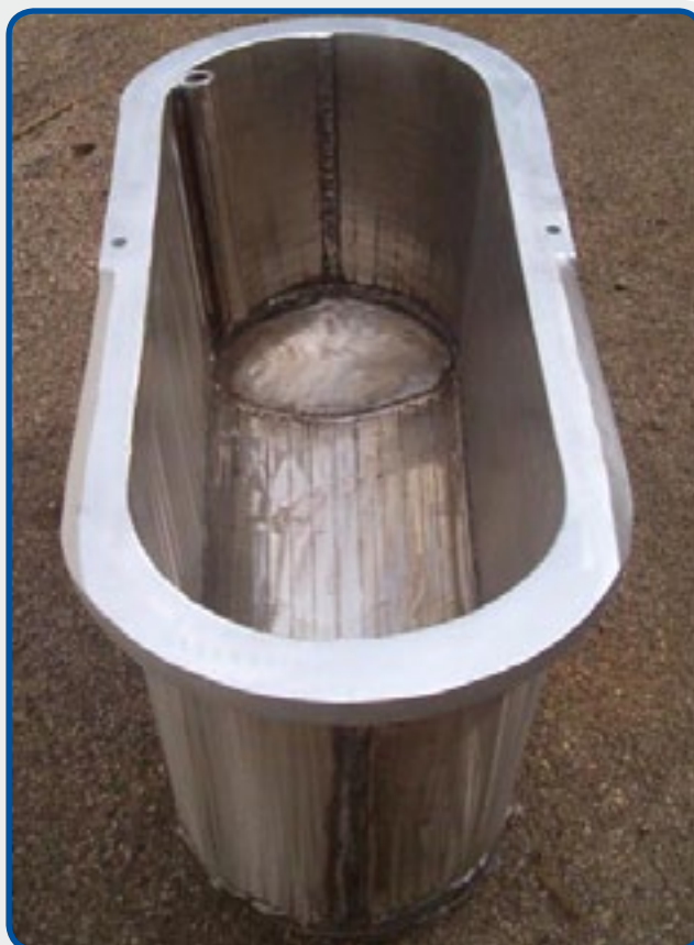
15. Тигель для переплавки цинковых сплавов, вместимость 380 кг.
