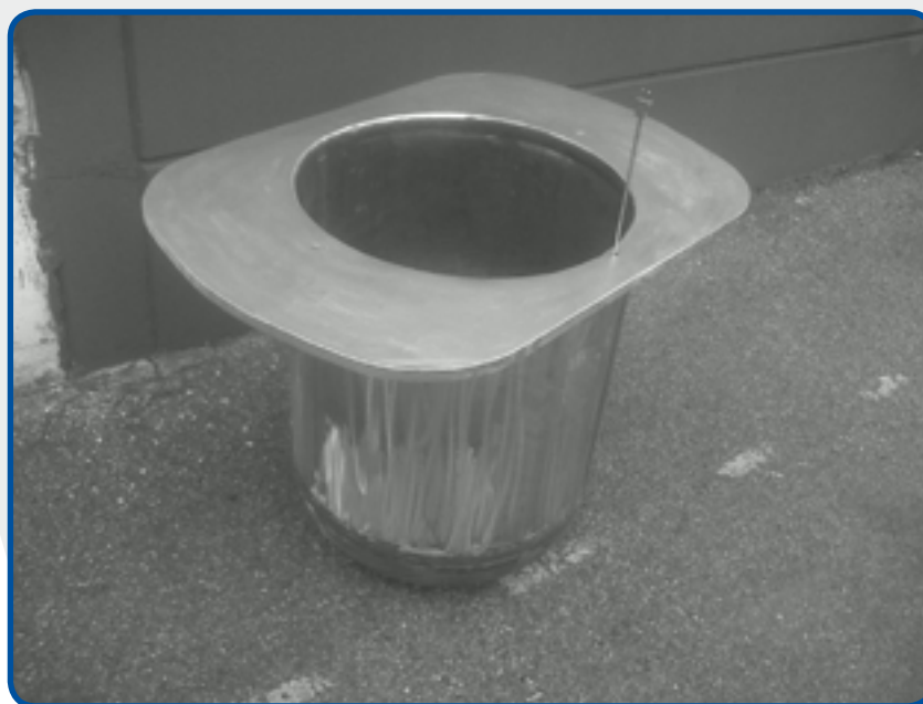
2. Schmelztiegel für Spezialanwendungen: Reinzink.
