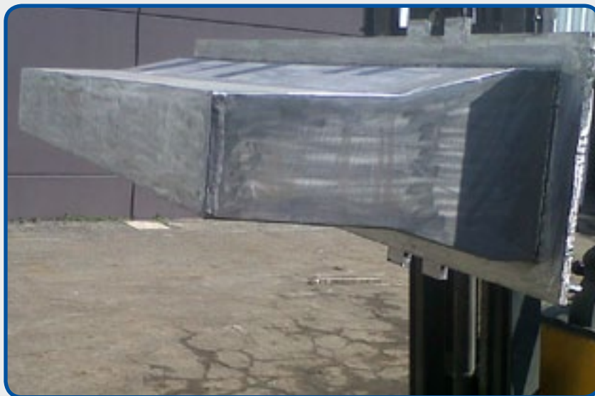
13. Тигель для переплавки цинковых сплавов.
