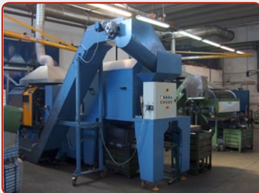
9. Forno completo attrezzato per recupero materozze (misure d'ingombro e dettagli secondo richiesta del Cliente).
