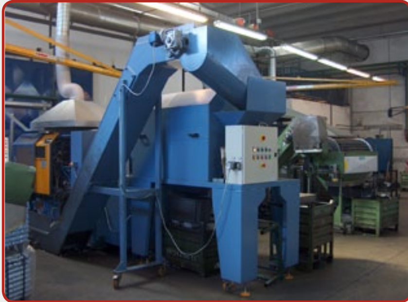
9. Komplettausgerüsteter Ofen für die Rückgewinnung von Zinkangüssen (Abmessungen und Details nach Kundenanfrage).
