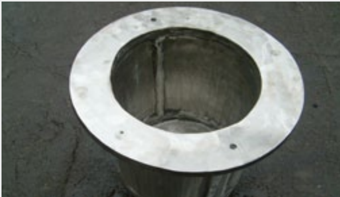
Schmelztiegel für Zinklegierungen
