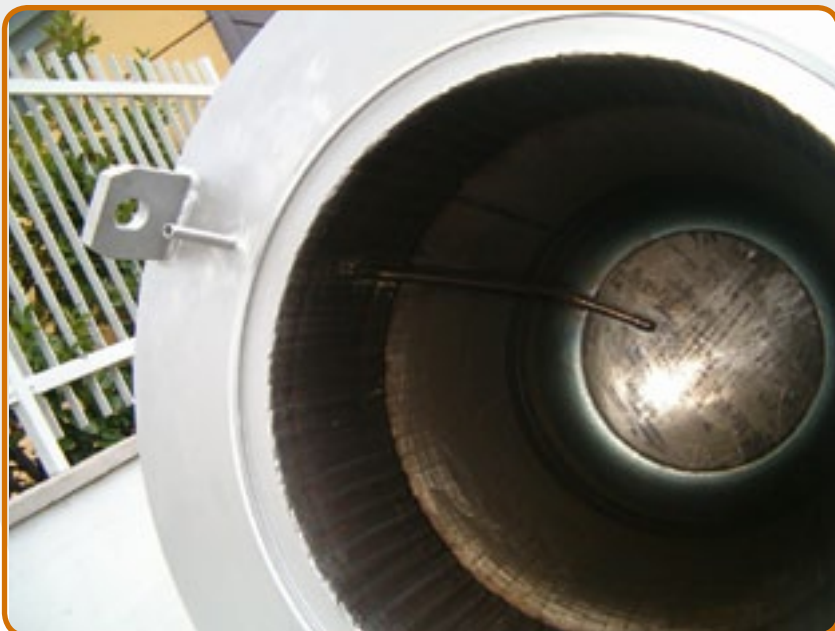
20. Crisol para la fundición de aleaciones de magnesio a baja presión .
