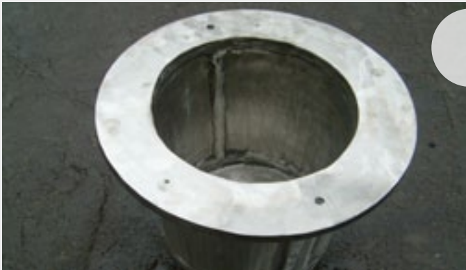
Creusets en acier inox pour alliages de zink
