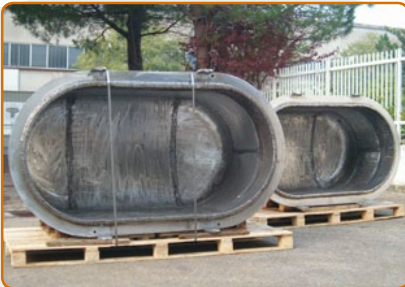
11. Interne Schutzbeschichtung gegen Korrosion durch SF 6 -Gase.
