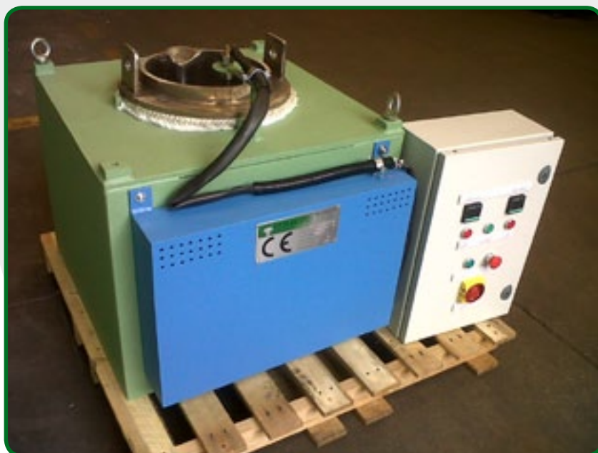
10. Печь для плавки цинка, электрический нагрев.
