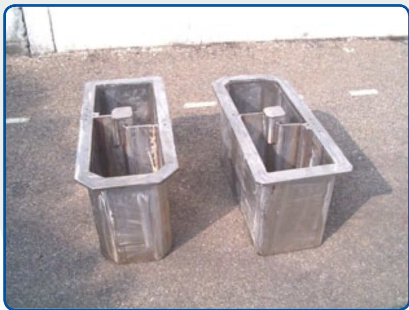
4. Тигель с двумя чашами для литья под давлением цинковых сплавов.
