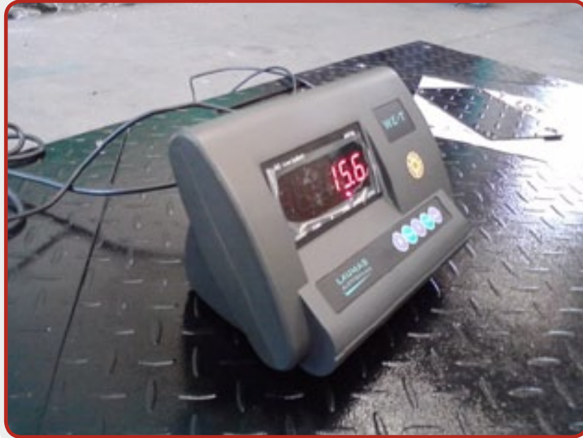
10- لوحة التحكم الرقمية للميزان .
