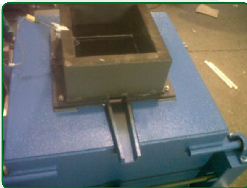
5. Forno rovesciabile, capacità pb / zn 500 kg.
