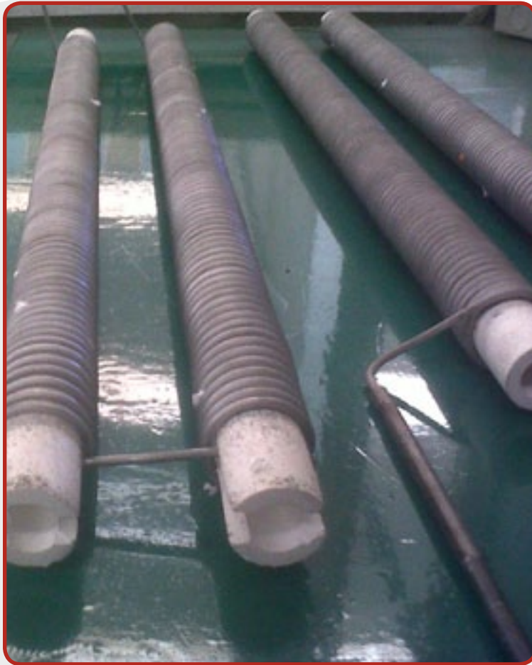
13. Auf Keramikträger gewickelte elektrische Heizelemente
