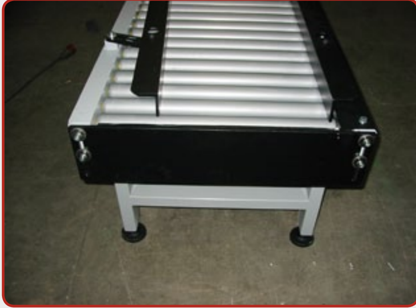
7- ناقل باسطوانة لمنظومة التعبئة والتغليف (شاملة الأبعاد والتفاصيل وفقا لطلب العميل )
