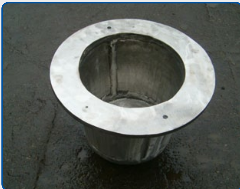
1. Creuset pour centrifuge de 300 kg pour les alliages zamak.
