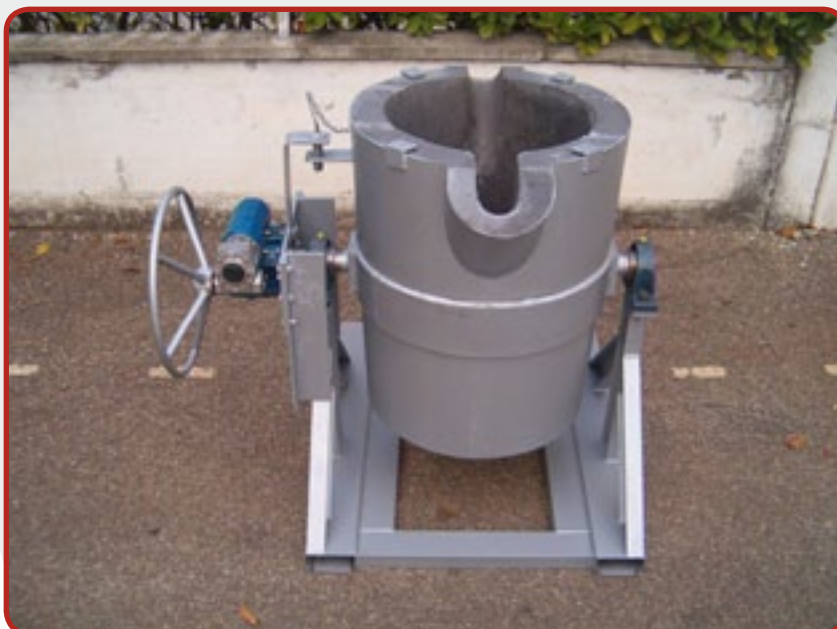
8. Siviera di travaso motorizzata per Al (misure d'ingombro e dettagli secondo richiesta del Cliente).
