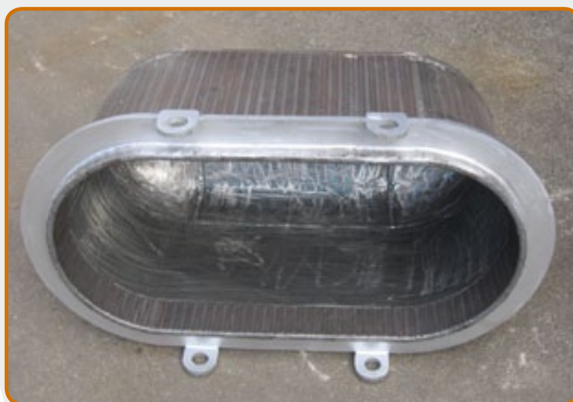
24. Тигель для магниевых сплавов, вместимость 4 тонны.
