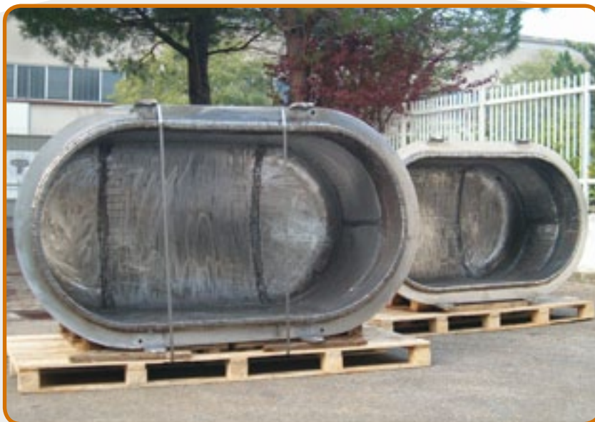
11. Rivestimento di protezione interna, contro la corrosione dei gas SF6.
