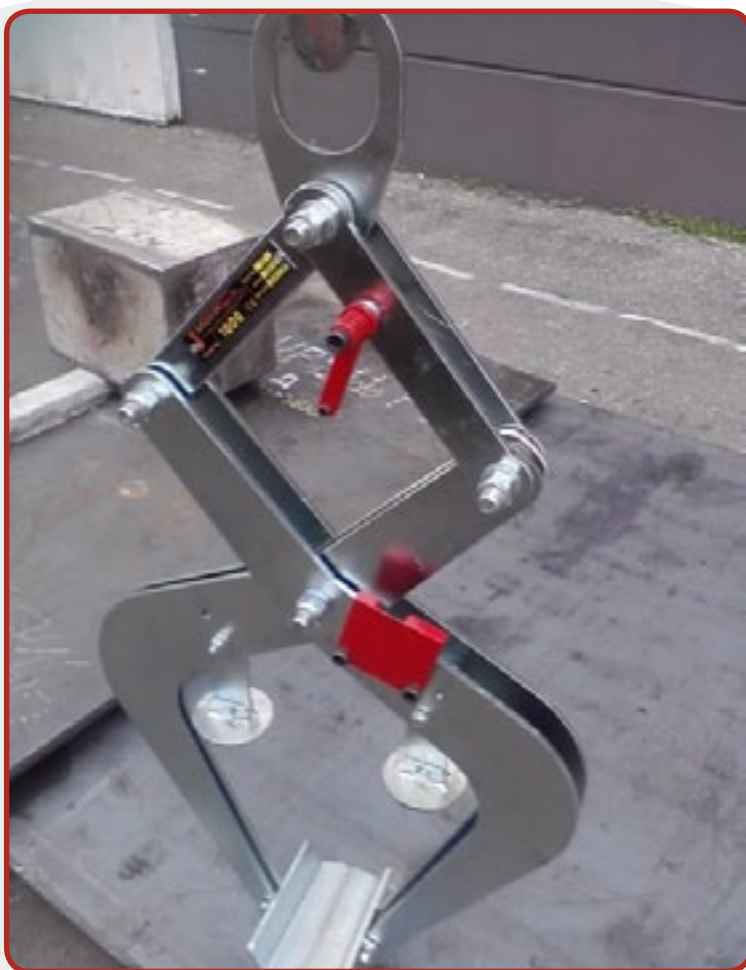
5. Щипцы с двойным пантографом для загрузки отливок, с предохранителями с автоблокировкой при ёме
