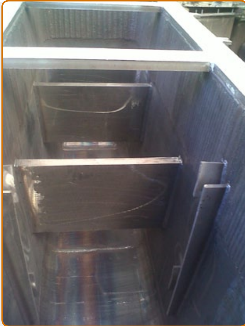
مغ 9. بوتقة لإعادة التدوير لسبائك المغنسيوم ، قدرة 2.2 طن.
