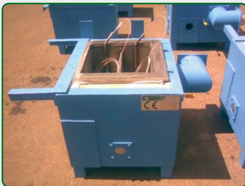
8. 瓦斯加热，配有温度探头的双池坩埚炉。
