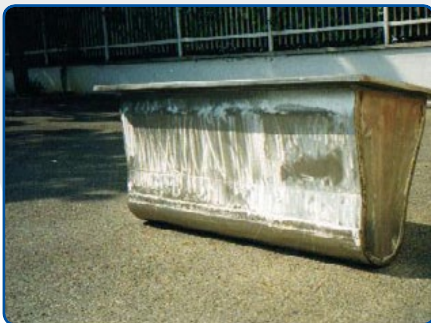
16. Crogiolo di rifusione per leghe di zinco, capacità 2500 KG.
