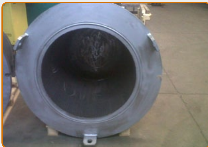
13. Crogiolo per la fusione in gravità, capacità 500 kg.
