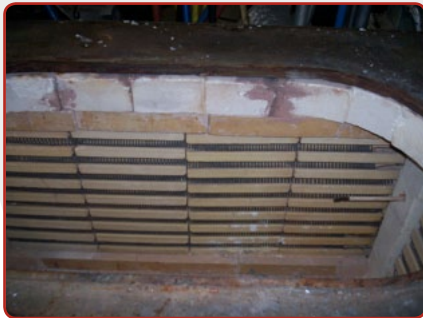
14 مقاومة كهربائية على شكل حلزوني على مسطح
