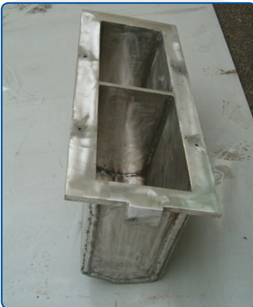
5. Crisol doble cámara para la fundición a presión de aleaciones de cinc.
