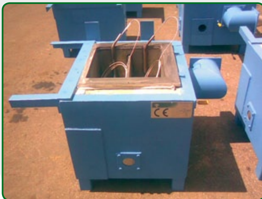
8. Печь тигельная с двумя литниковыми чашами, газовый нагрев, в комплекте с температурными зондами.
