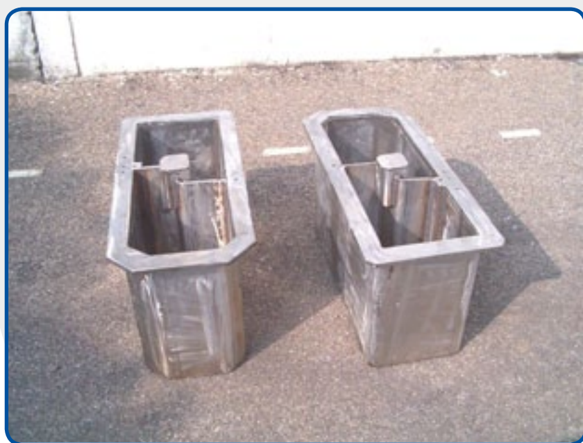
4. Crisol doble cámara para fusión de aleaciones de cinc.
