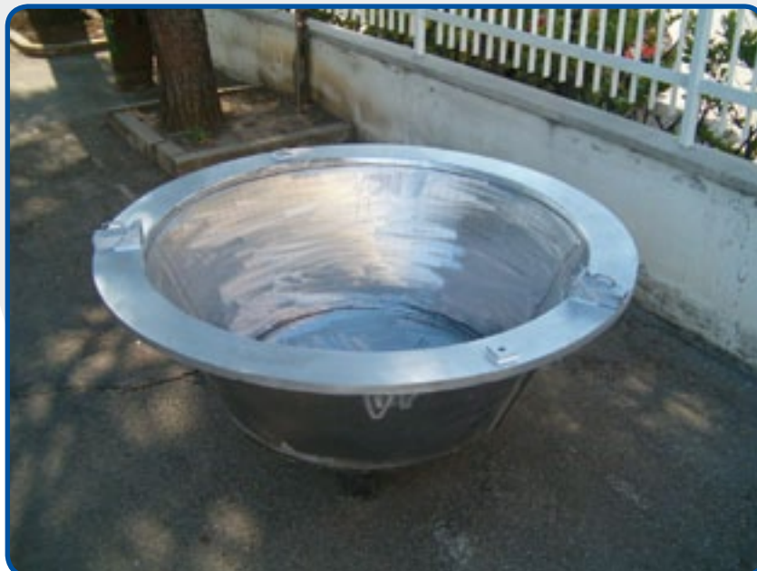
6. Schmelztiegel zum Umschmelzen und für das Raffinieren von für Zinklegierungen
