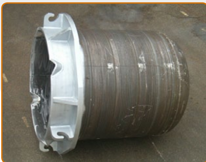
4. Crogiolo per riciclaggio delle leghe di magnesio.
