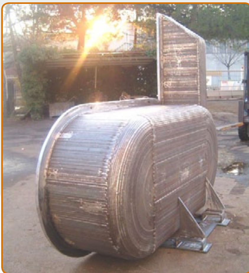
2. Тигель для переплавки магниевых сплавов.
