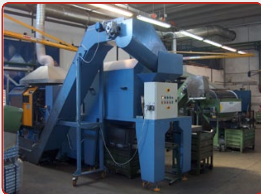
9. 为浇口回收的全套炉子 (体积尺寸和细节可以根据客户的要求定制)。
