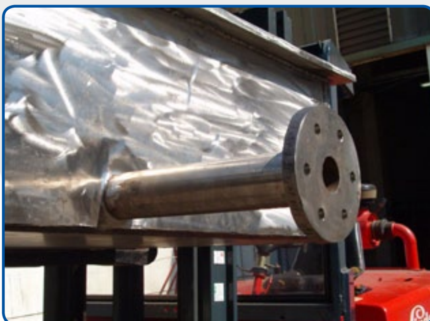
8. Creuset 10 ton zinc.
