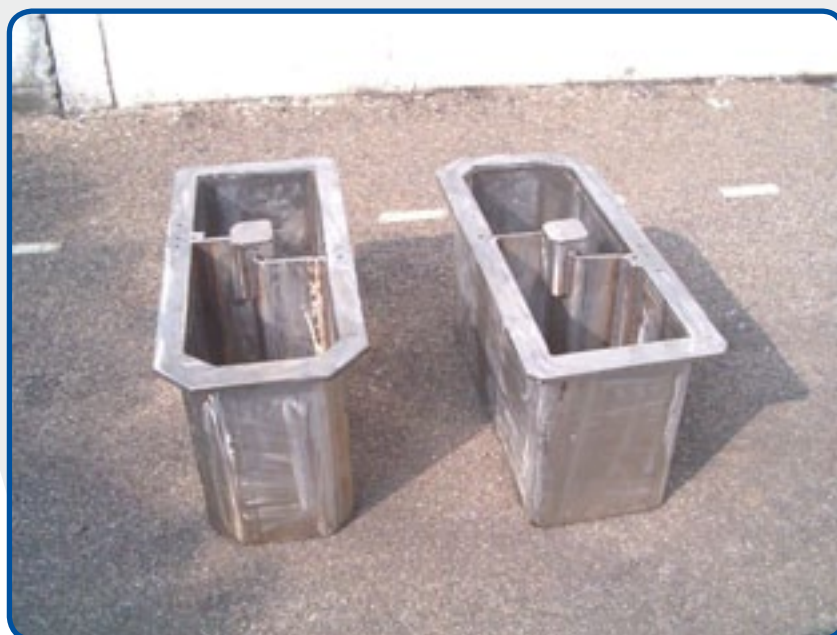
4. Zweikammertiegel für den Druckguss von Zinklegierungen.
