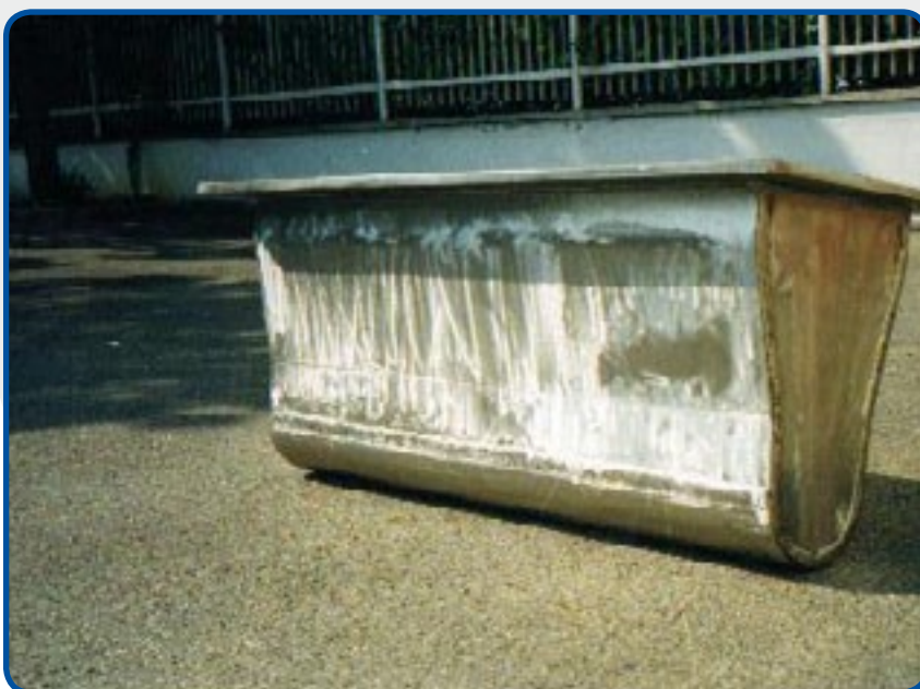
16. Creuset de refusion pour les alliages de zinc, capacité de 2500 kg.
