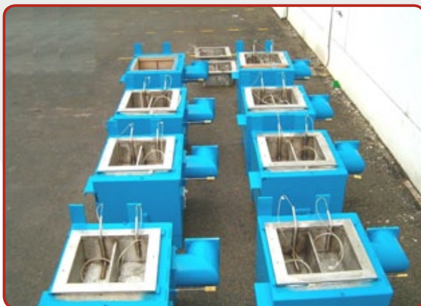
2. 设有温度传感器的双池设备 (体积尺寸和细节可以根据客户的要求定制)。
