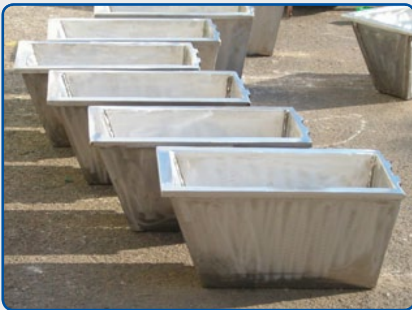
3. Использование тиглей для производства свинца в установке для производства цинка.
