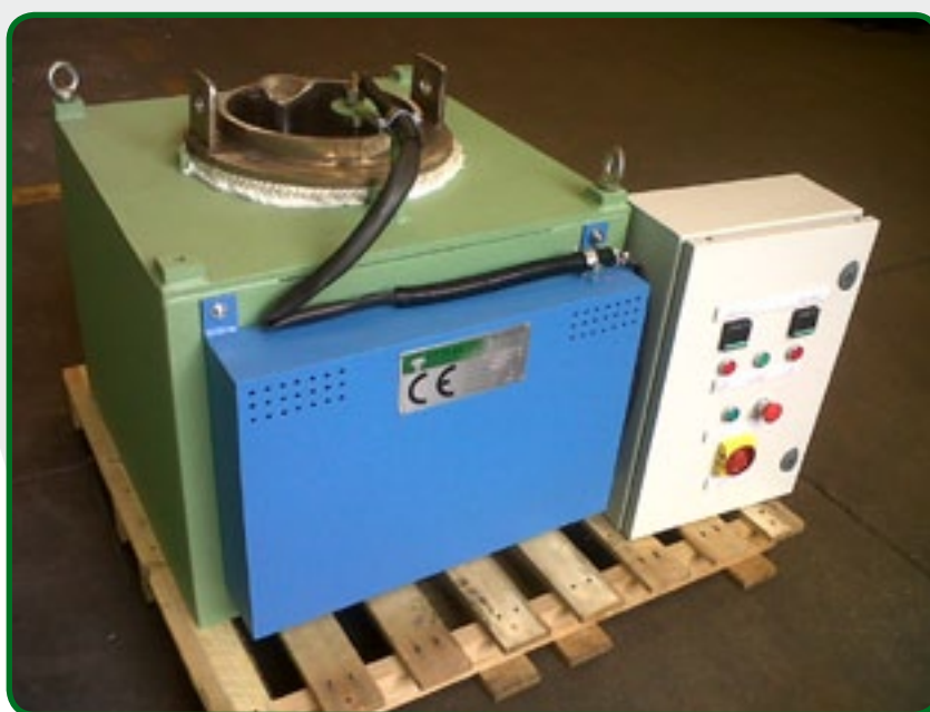
10. Four pour ZN, chauffage electrique.
