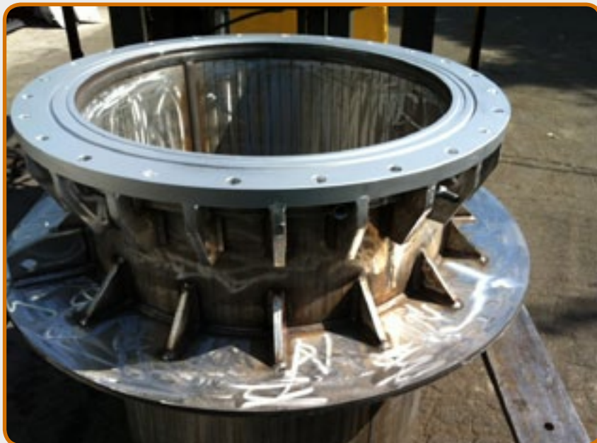
1. Crogiolo per leghe di magnesio per fusione in bassa pressione.
