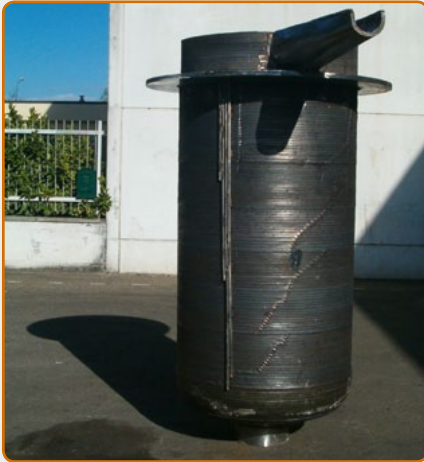
3. Schmelztiegel für die Wiederverwertung von Magnesiumlegierungen
