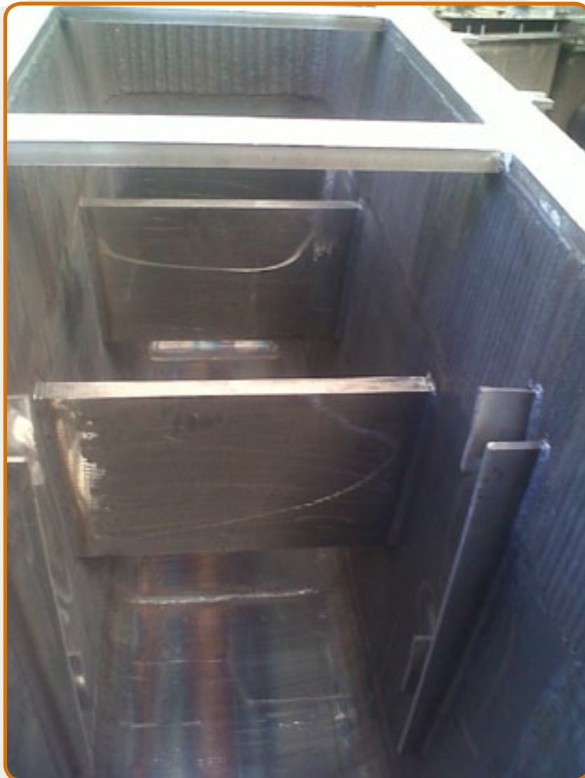
9. Schmelztiegel für die Wiederverwertung von Magnesiumlegierungen, Fassungsvermögen 2,2 t.
