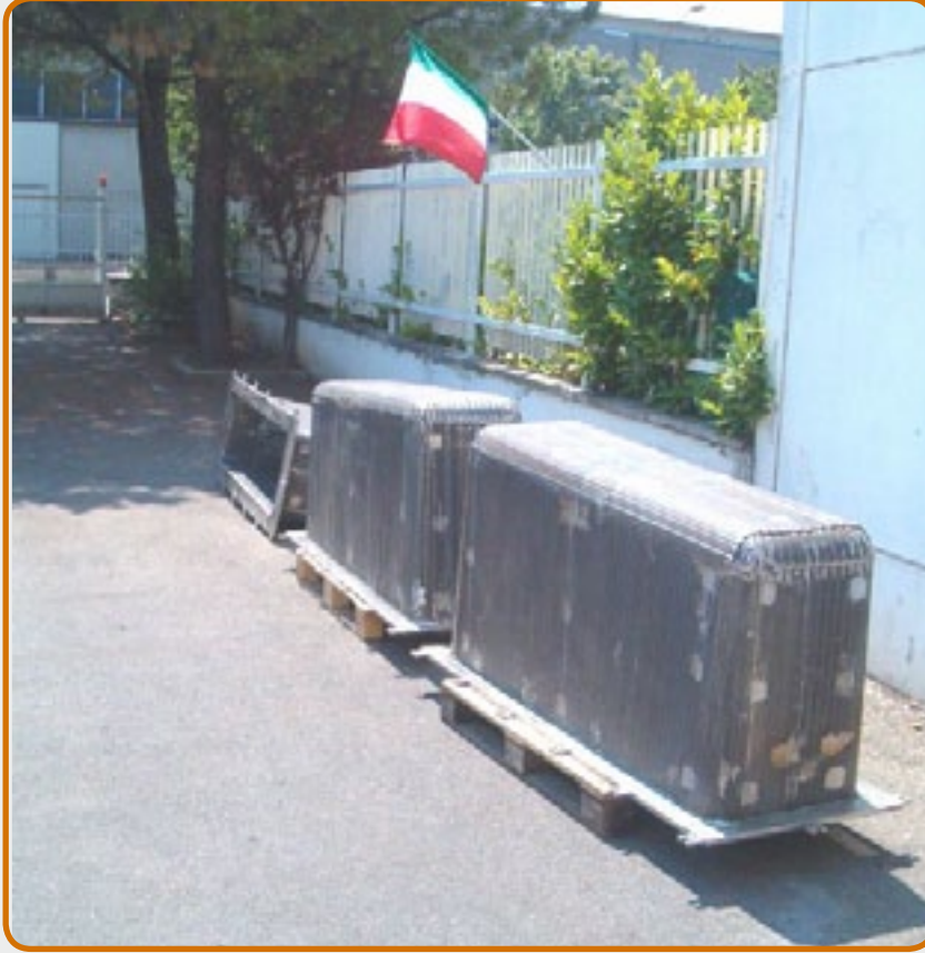
مغ 25. بوتقة لإعادة التدوير لسبائك المغنسيوم ، قدرة 1 طن
